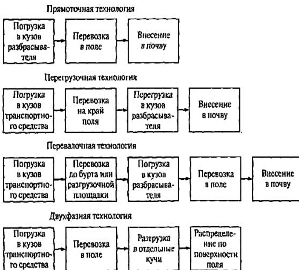
Рисунок 4.1 – Технологические схемы основного внесения удобрений
