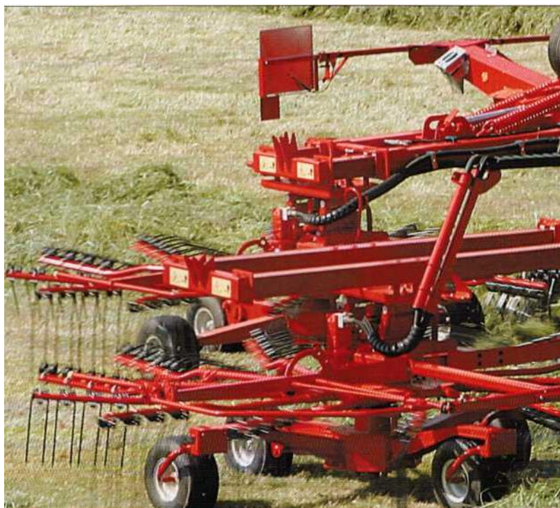
Рисунок 237 – Вид независимого гидравлического привода для каждого ротора
