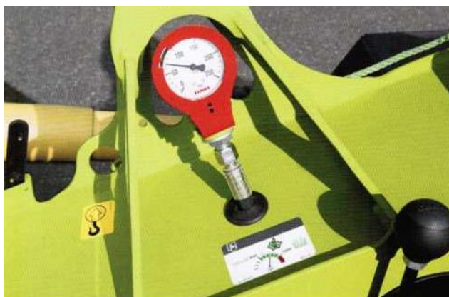
Рисунок 134 – Вид системы переноса веса косилки с дернины на трактор
