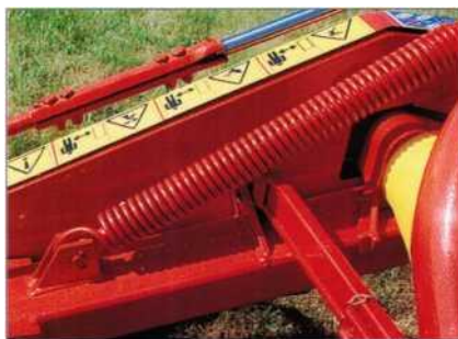
Рисунок 224 - Компенсирующая пружина бруса
