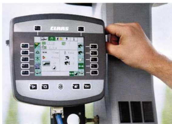
Рисунок 97 - Цветной монитор с функцией управления давлением прессования
