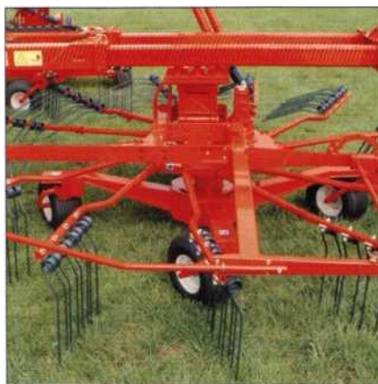
Рисунок 245 – Вид вращающегося и саморегулирующегося шасси
