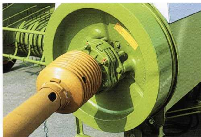
Рисунок 116 - Вид маховика с проскальзывающей муфтой
