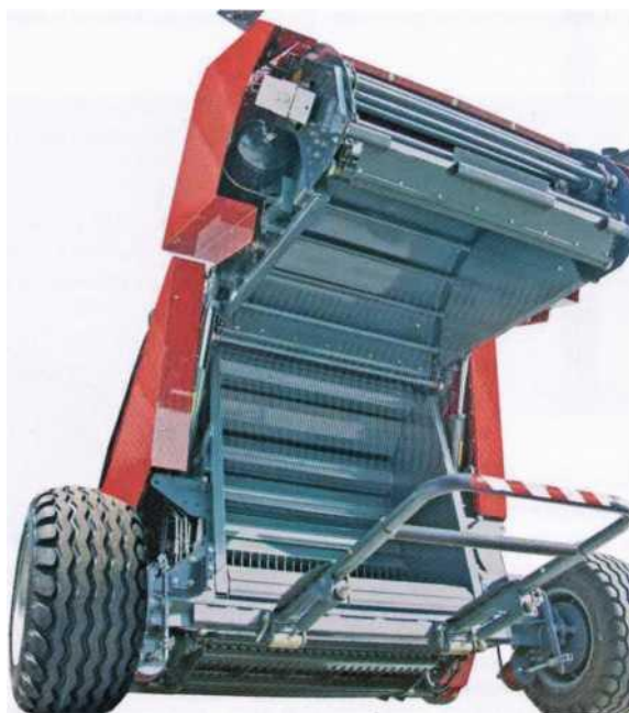
Рисунок 54 – Вид рабочих органов прессовальной камеры Rollprofi
