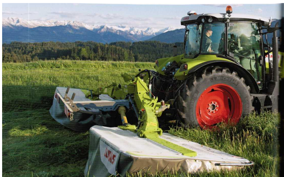
Рисунок 124 – Вид агрегатирования задних секций косилочного агрегата
