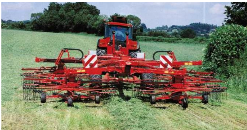
Рисунок 235 - Вид четырёхроторного валкообразователя GA 15021 с уменьшенной шириной захвата
