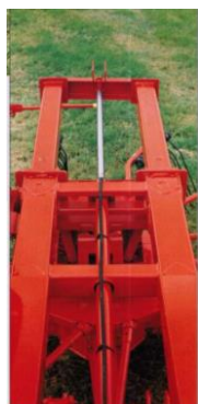
Рисунок 241 – Вид двойных кронштейнов роторов с механизмом управления
