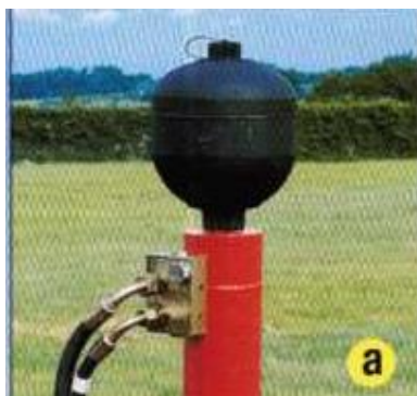
Рисунок 254 – Вид гидропневматического механизма подъёма шасси валкообразователя
