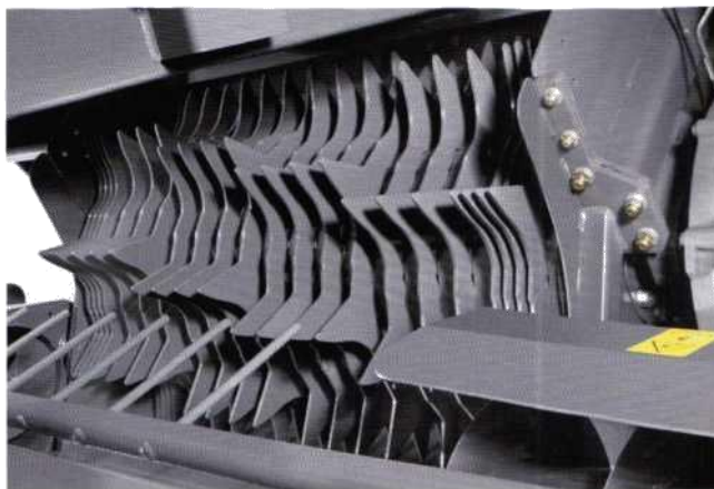
Рисунок 88 - Высокопроизводительный ротор пресс-подборщика QUADRANT 3400
