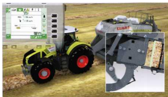
Рисунок 123 – Система управления плотностью прессования
