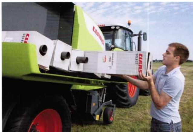
Рисунок 100 – Вид гидравлически опускающегося ящика пленки
