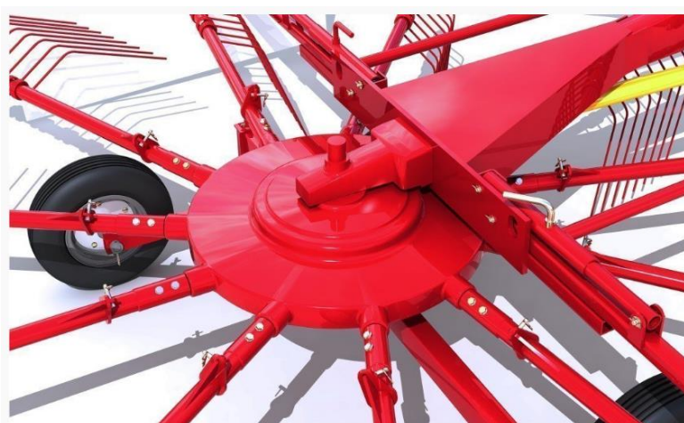
Рисунок 3 – Вид герметичного ротора граблей «Kolibri»
