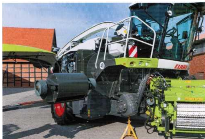
Рисунок 63 – Простой демонтаж ускорительного барабана
