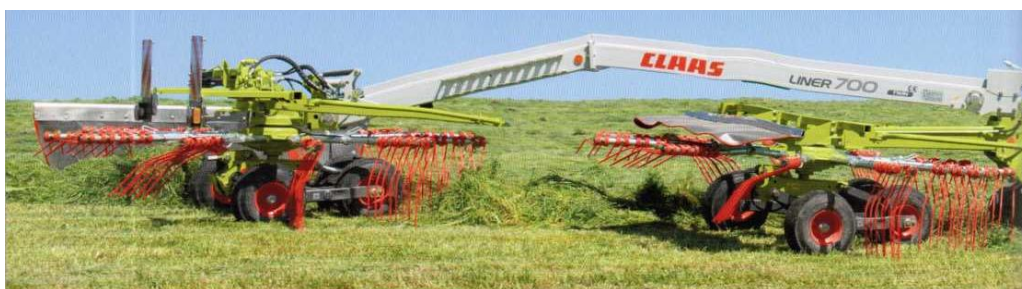
Рисунок 162 – Расположение секций валкоукладчика с боковой укладкой LINER.
