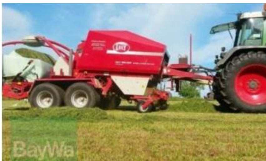
Рисунок 171 - Пресс-подборщик Double Action RP 235 фирмы «Welger» с рулонообматывающим устройством (Германия)
