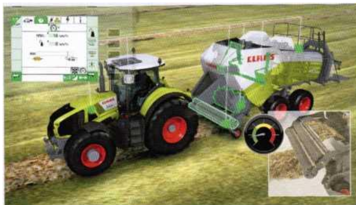
Рисунок 121 – Система контроля оптимальной загрузки за счёт корректировки скорости движения
