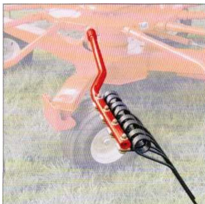
Рисунок 250 – Форма граблин с двумя изгибами
