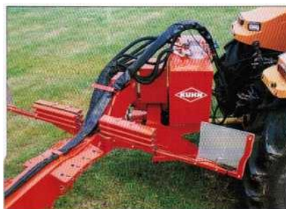
Рисунок 238 – Вид поворотного механизма, обеспечивающего соосность карданного вала
