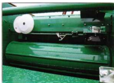
Рисунок 42 – Рабочий орган пресс-подборщиков ПРИ-150 и ПРМ-150
