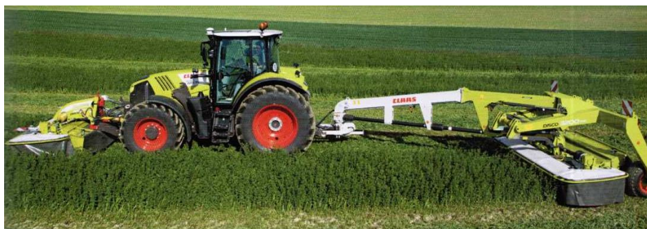
Рисунок 142 – Косилка DISCO в варианте с центральным и боковым ДЫШЛОМ
