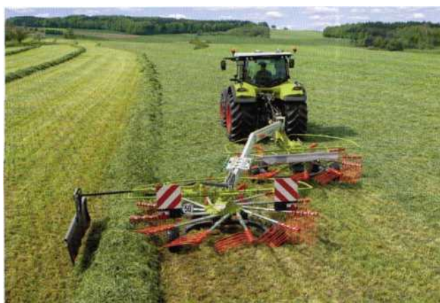
Рисунок 129 – Вид двухроторной модели граблей-валкователей LINER 700 TWIN
