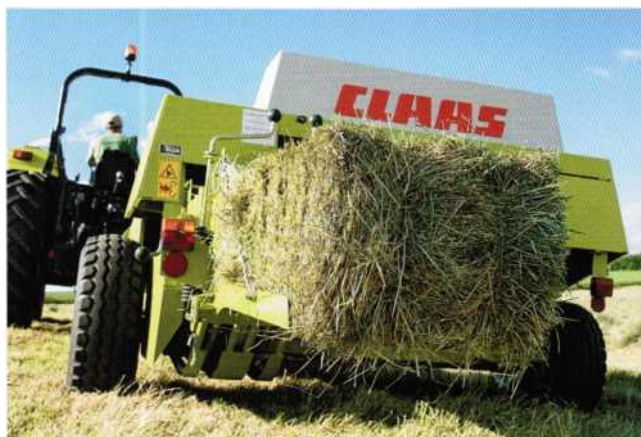
Рисунок 115 – Вид сформированного тюка улучшенной формы
