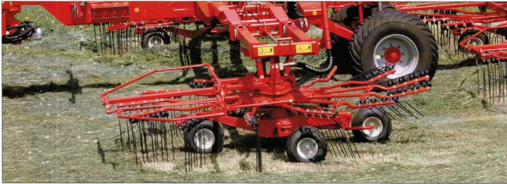
Рисунок 243 - 3D подвеска: зубья, точно следующие рельефу почвы
