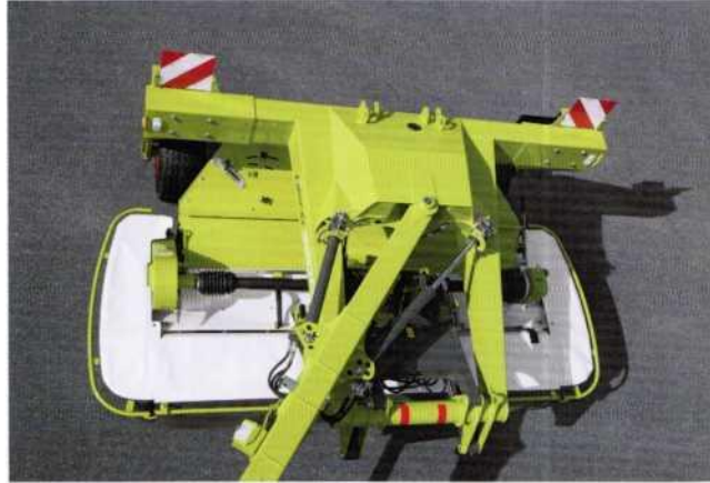
Рисунок 144 – Вид механизма поворота косилки за счет комбинации двух цилиндров двойного действия
