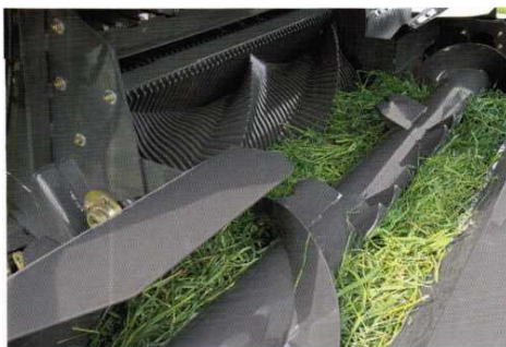
Рисунок 84 – Вид ротора и подающего устройства для широких валков
