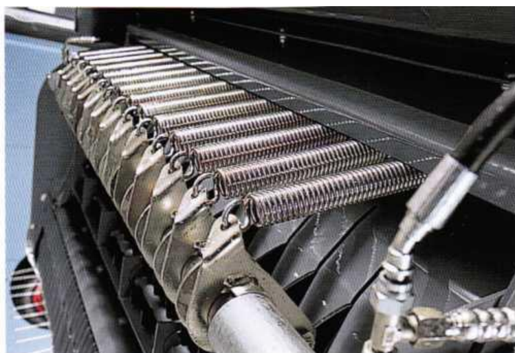
Рисунок 104 – Вид пружинного механизма крепления ножей
