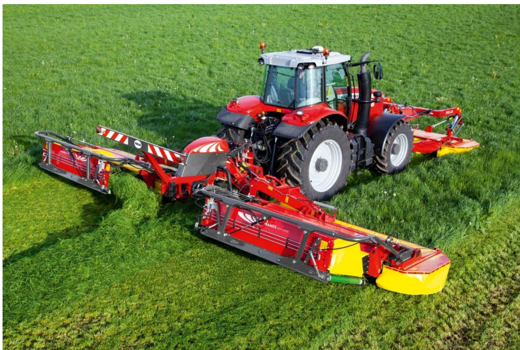
Рисунок 178 - Укладка травы по направлению внутрь поля косилкой SM311 Trans фирмы «Fella» (Германия)
