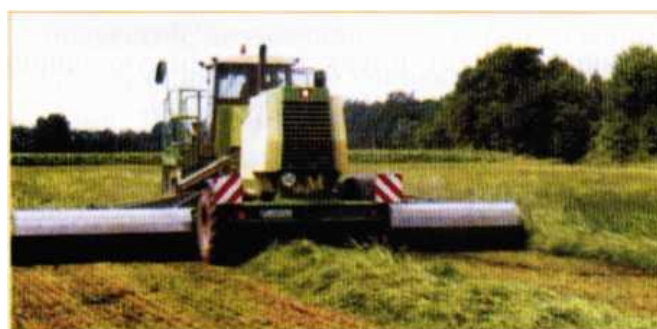
Рисунок 168 - Самоходная косилка «Big M II» фирмы «Krone» с устройством объединения валков «Big Swath System»
