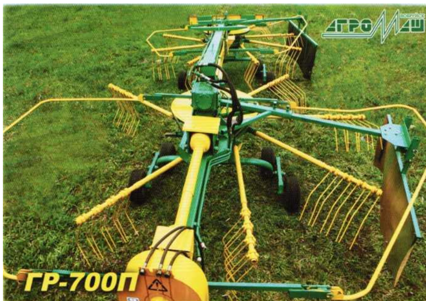
Рисунок 30 – Компоновка рабочих органов граблей ГР-700П
