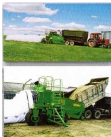
Рисунок 46 – Загрузка массы в упаковщик из различных транспортных средств
