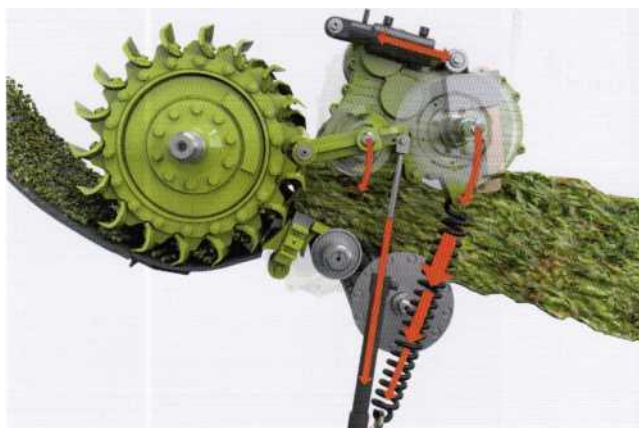
Рисунок 59 – Процесс подачи предварительно подпрессованной массы и её измельчение ножевым барабаном V-MAX
