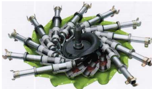
Рисунок 158 - Герметично закрытое роторное колесо PROFIX валко-укладчика LINER
