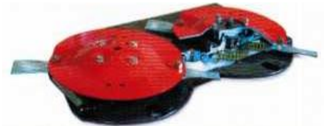
Рисунок 190 – Устройство режущего аппарата косилки-плющилки серии Таагуп 4300
