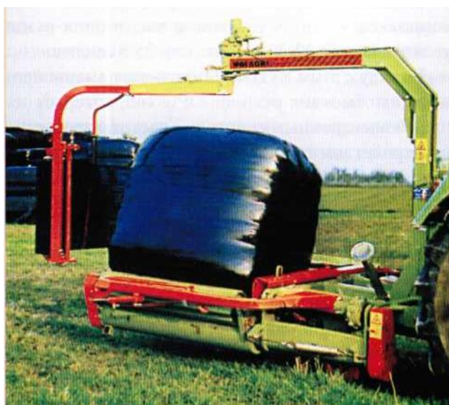
Рисунок 199 - Упаковщик тюков в пленку FW 12S/4K фирмы «Wolagri» (Италия) с бобиной, вращающейся вокруг тюка
