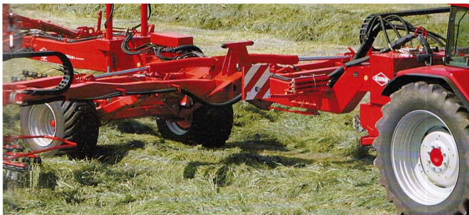
Рисунок 240 – Вид устройств для защиты шлангов
