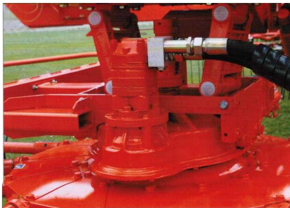
Рисунок 239 – Вид ротора граблин с предохранительными клапанами
