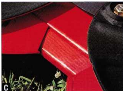
Рисунок 222 - Защитные бронированные щитки косилочного бруса
