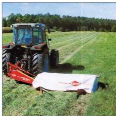
Рисунок 231 - Внутренний щиток для укладки узкого валка
