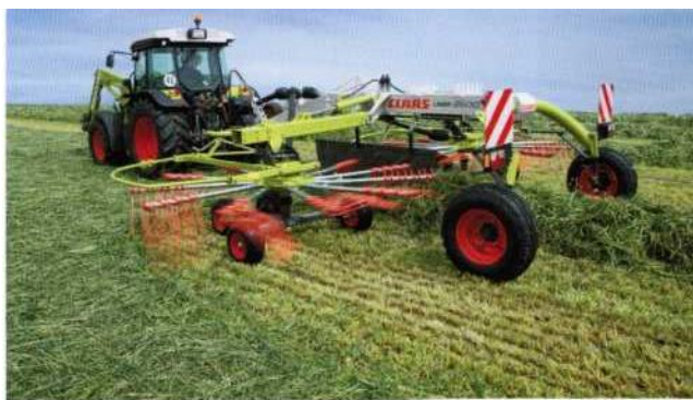
Рисунок 160 - Адаптацию к рельефу почвы вдоль и поперек направления движения
