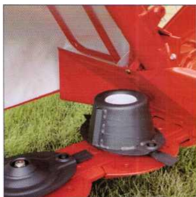
Рисунок 232 - Дополнительный диск-конус (GMD 55 Select и GMD 77HD Select)
