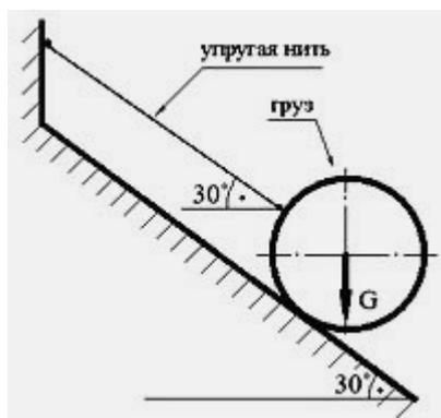
*Найти силу натяжения упругой нити, удерживающей груз в состоянии равновесия на идеально гладкой наклонной плоскости.*
