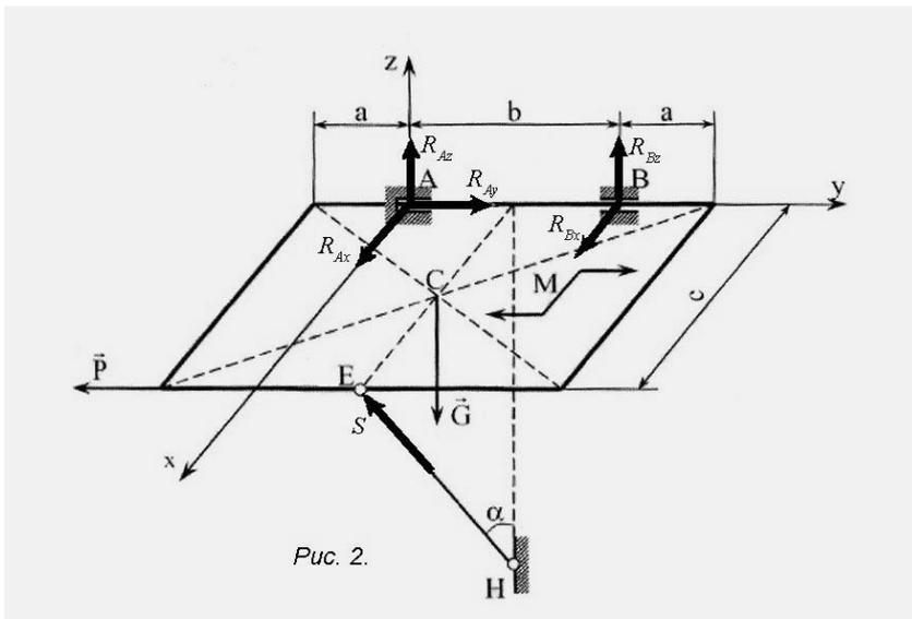
2. Для определения искомых компонент реакций опор составим уравнения равновесия для данной конструкции относительно выбранной системы координат.
