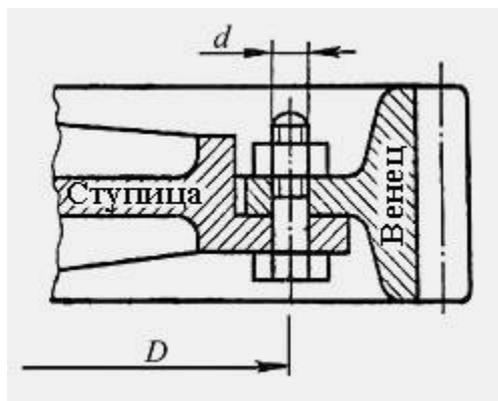
Определить касательные напряжения сдвига (среза), действующие в каждом из болтов при номинальной нагрузке.
