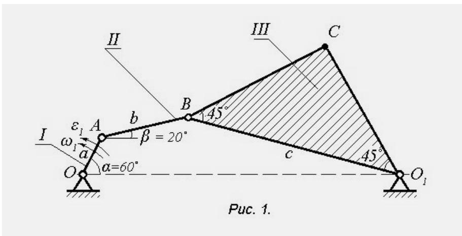
Определить в момент времени  $t_1$  модули угловых скоростей  $\omega_2$  и  $\omega_3$ , угловых ускорений  $\varepsilon_2$  и  $\varepsilon_3$  звеньев *II* и *III*, а также модули скоростей  $v_A$ ,  $v_B$ ,  $v_C$  и ускорений  $a_A$ ,  $a_B$ ,  $a_C$  точек *A*, *B*, *C*.
