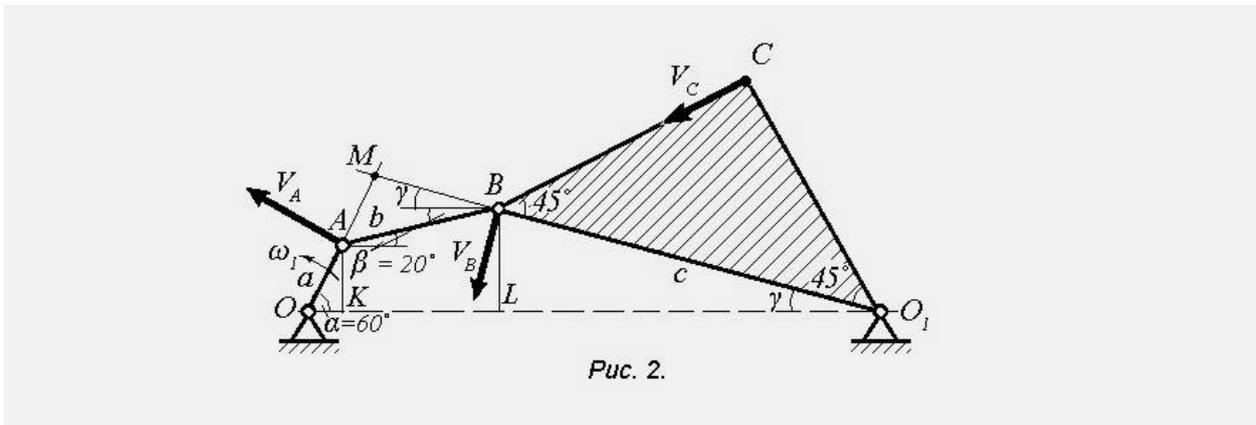
Касательное ускорение точки  $A$  определится, как произведение длины звена  $OA$  на угловое ускорение  $\varepsilon_I$  этого звена:
