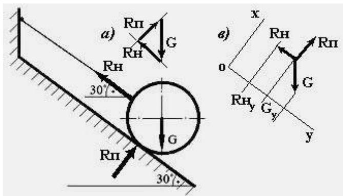
Для реакций мы знаем лишь их направление (величина сил неизвестна). От концов вектора силы  $G$  откладываем отрезки прямых, параллельные реакциям, и точка пересечения этих прямых позволит нам получить искомый треугольник сил. Теперь можно определить величину любой из реакций, измерив ее длину на чертеже линейкой и умножив на масштаб чертежа, который задает сила  $G$ . Порядок построений показан на *рисунке а*).
