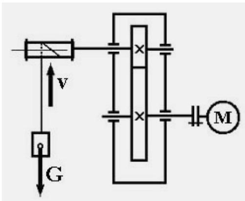
Лебедка состоит из цилиндрической передачи и барабана, к которому посредством троса прикреплен груз  $G$ . Определить требуемую мощность  $P_M$  электродвигателя лебедки, если скорость подъема груза должна составлять  $v = 4$  м/сек.
