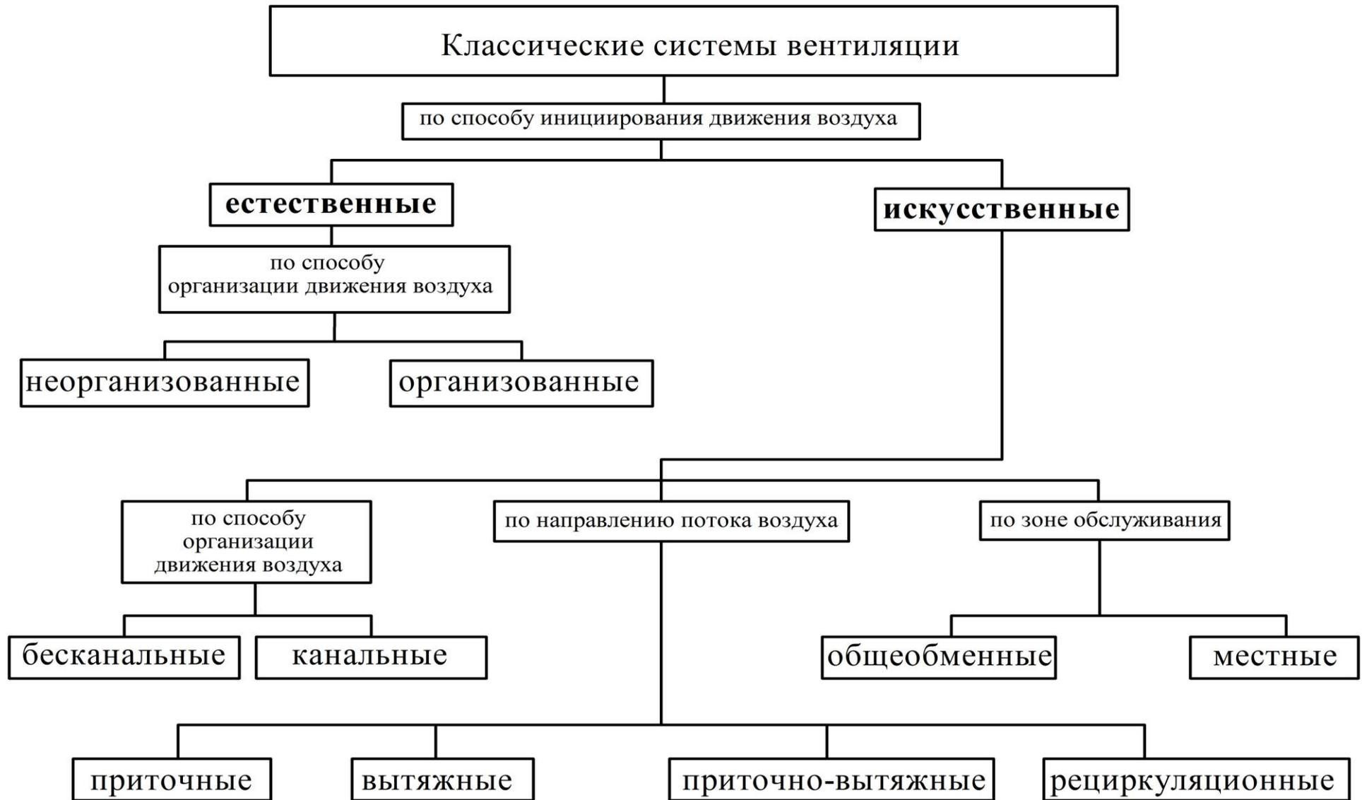
*Рис. 4.* Классификация существующих систем вентиляции
