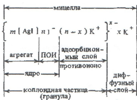
Схема строения мицеллы золя иодида серебра с отрицательно заряженными частицами
