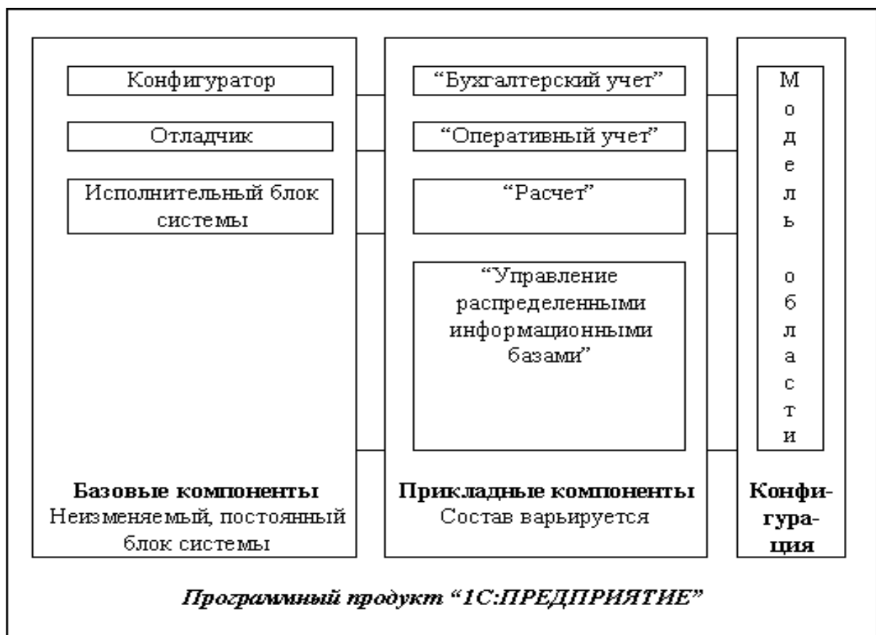
Рис. 5. Структурная схема системы «1С: Предприятие»
