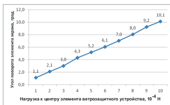
Рисунок 3 – Изменение угла наклона элемента ветрозащитного устройства от действующей силы воздушного потока
