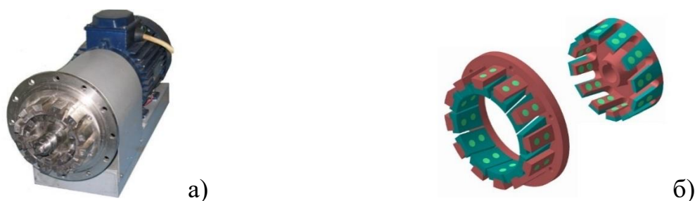
Рисунок 3 - Рабочие органы установки для тонкого измельчения мясного сырья: а) фотография; б) трехмерная компьютерная модель
