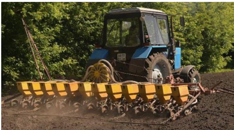
Рисунок 4 – Сеялка для гнездового посева сои с системой контроля высева семян
