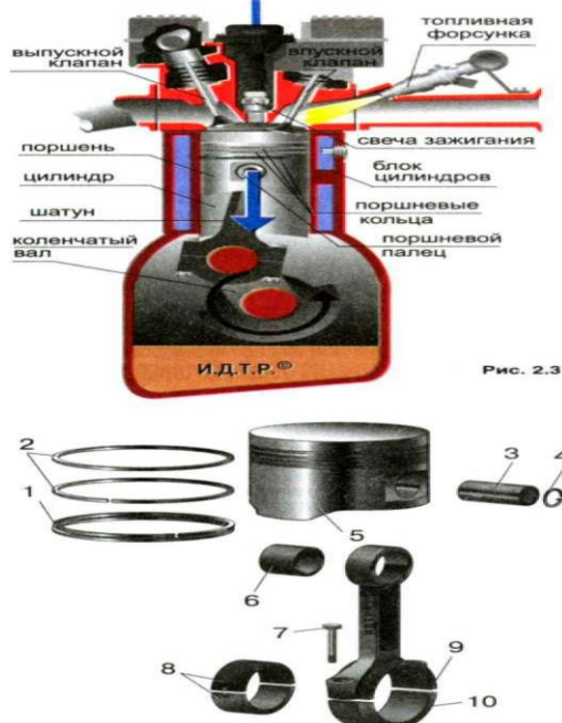
Рис. 3.3. Поршень: 1 - маслосъемное кольцо; 2 - компрессионные кольца; 3 - поршневой палец; 4 – стопорное кольцо; 5 - юбка поршня; 6 - втулка; 7 - болт; 8 - вкладыши; 9 - шатун; 10 - крышка шатуна
