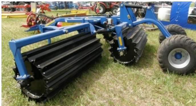
Рис. 2. Мульчировщик с ножевыми катками MaxiCut 600
