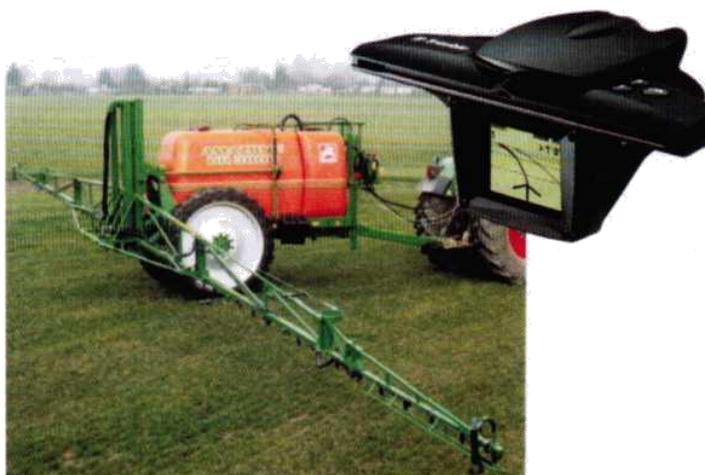
Рисунок 60 – Прицепной опрыскиватель UR 3000 с системой параллельного вождения
