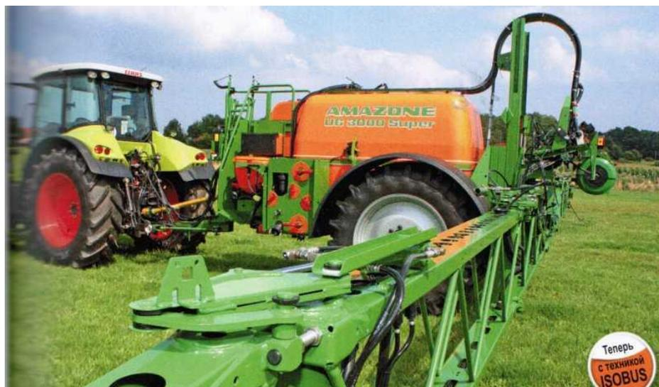
Рисунок 88 – Прицепной опрыскиватель UG 3000 Super в рабочем положении
