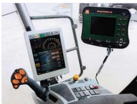
Рисунок 104 – Вид джойстика AmaPilot и терминала AMADRIVE
