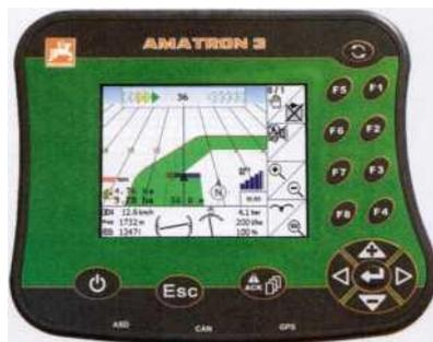
Рисунок 105 – Вид обзорного терминала управления AMATRON 3
