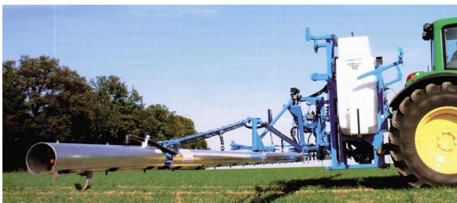
Рисунок 34 – Навесной опрыскиватель ЕвроЛюкс фирмы LEMKEN
