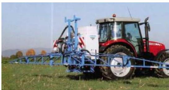
Рисунок 35 – Компактная навеска на трактор, низкая разгрузка передней оси трактора
