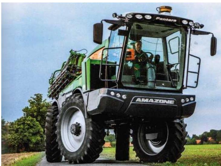
Рисунок 100 – Вид самоходного опрыскивателя Pantera 4502 с компактной конструкцией и управлением всеми колёсами
