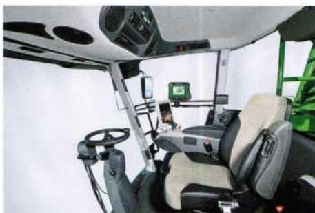
Рисунок 101 – Расположение органов управления в кабине опрыскивателя Pantera 4502
