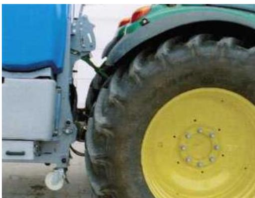
Рисунок 41 – В рабочем положении система QuickConnect минимизирует расстояние между трактором и навесным агрегатом, центр тяжести смещается вперед.
