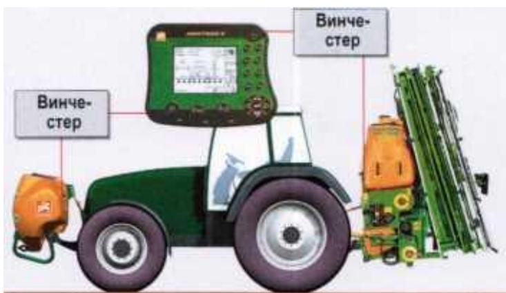
Рисунок 70 – Схема управления с помощью бортового компьютера АМАТРОН 3
