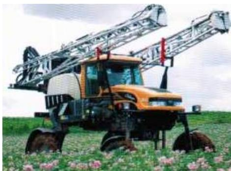
Рисунок 115 – Вид самоходного опрыскивателя SPRA-COUPЕ в транспортном положении
