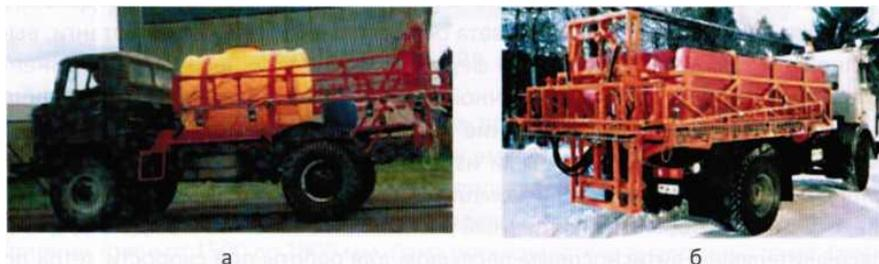
Рисунок 8 - Самоходные штанговые опрыскиватели на автомобильном шасси: а - ОМШ-2000, б - ОМШ-600
