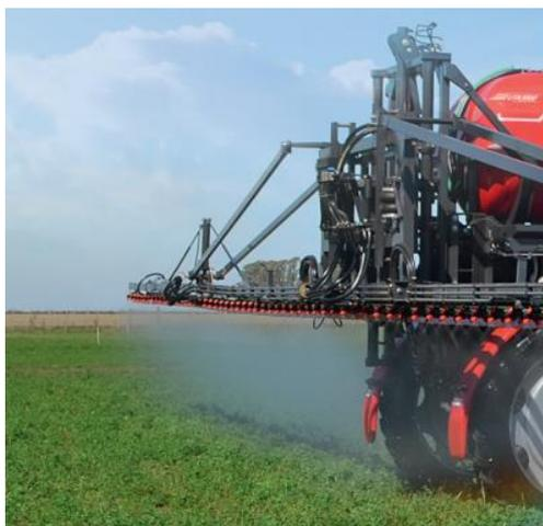
Рисунок 4 – Вид штанги и системы подвески опрыскивателя УТА-3000
