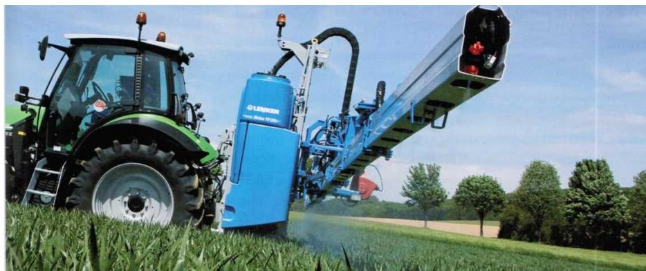
Рисунок 37 – Высокопроизводительный опрыскиватель для профессионального фермера
