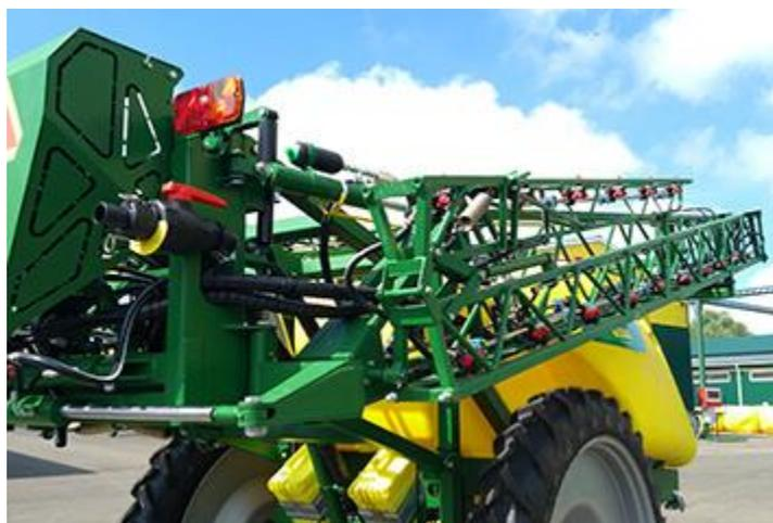
Рисунок 10 - Полуприцепной опрыскиватель «Гварта 8» («Агротех-Гарант»)
