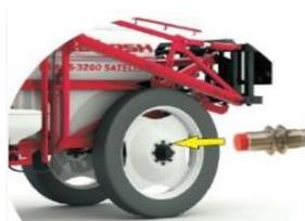
Рисунок 19 – Индуктивный датчик на ступице колеса опрыскивателя
