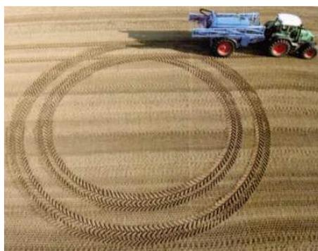
Рисунок 56 – Совпадение колеи при использовании поворачиваемого дышла
