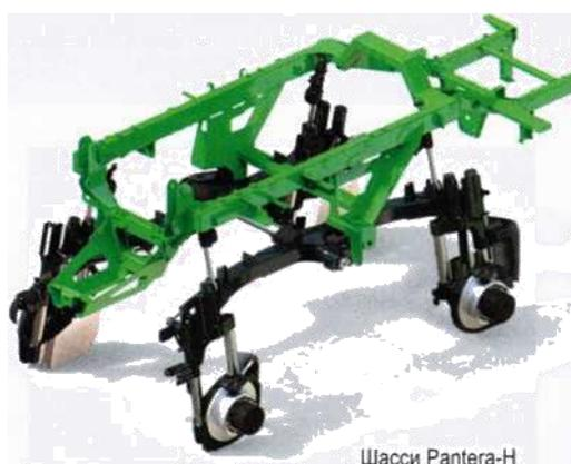
Рисунок 96 – Вид тандемного шасси
