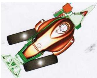
Рисунок 76 – Вид задних управляемых колёс
