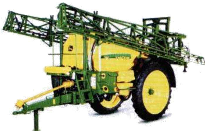
Рисунок 110 – Прицепной штанговый опрыскиватель 740
