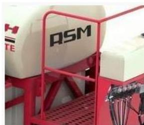
Рисунок 17 – Вид поста управления опрыскивателя RSM TS Satellite
