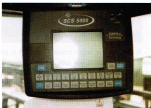
Рисунок 120 – Бортовой компьютер Raven 5000 опрыскивателей серии 7000
