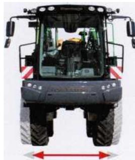
Рисунок 98 – Возможность автоматической регулировки колеи
