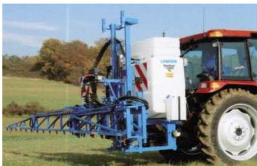
Рисунок 36 – Одностороннее складывание штанги SPH
