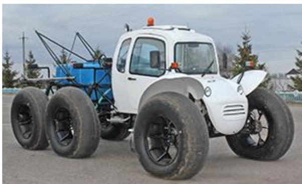
Рисунок 28А – Вид самоходного опрыскивателя «Роса»
