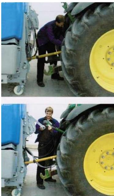
Рисунок 42 – Порядок присоединения опрыскивателя к трактору
