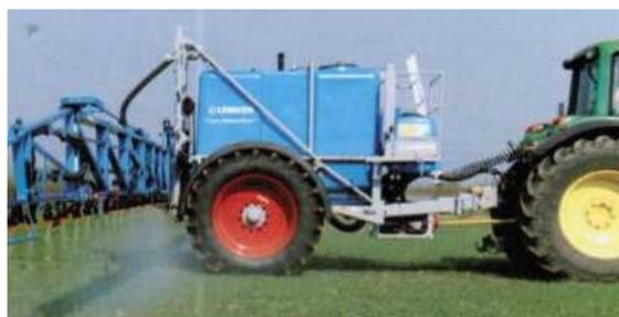
Рисунок 53 – Короткое дышло для точного следования по колее
