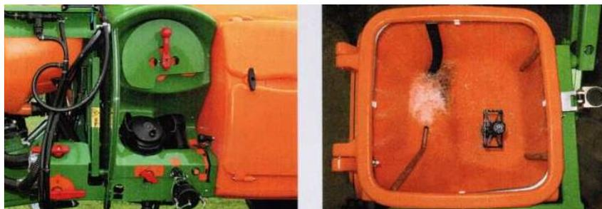
Рисунок 75 – Вид расположения элементов управления и откидного промывочного бака
