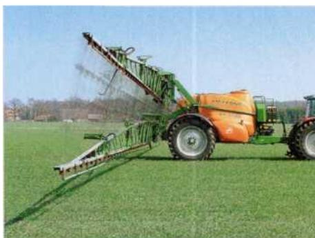
Рисунок 81 – Диапазон изменения высоты установки штанги с помощью параллелограммной подвеске
