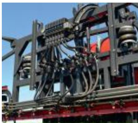
Рисунок 5 – Вид системы автоматического регулирования положения штанги опрыскивателя УТА-3000
