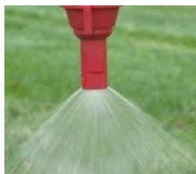
Рисунок 25 – Вид инжекторного распылителя
