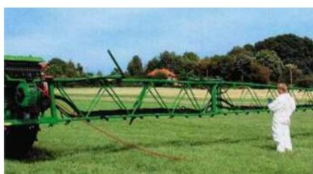
Рисунок 86 – Наружная очистка любого опрыскивателя AMAZONE в поле сразу после работы
