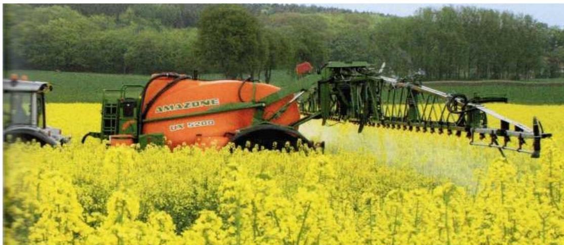
Рисунок 77 – Вид прицепного опрыскивателя UX 5200 Super
