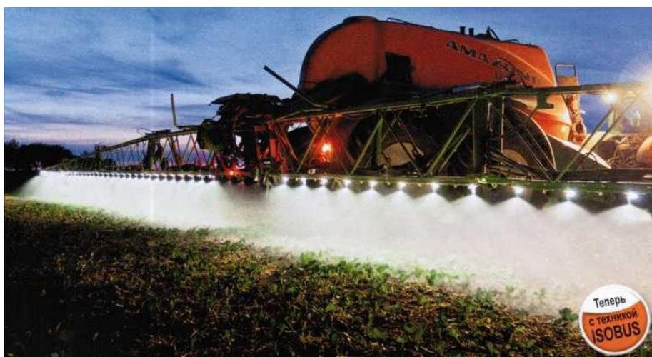
Рисунок 82 – Диодная подсветка области опрыскивания
