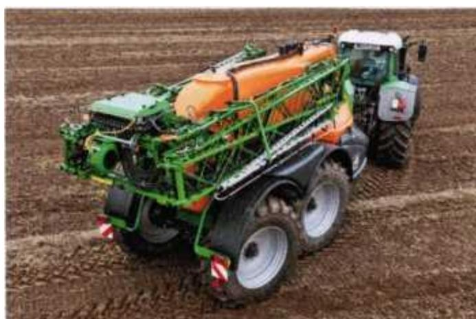
Рисунок 84 – Система маневрирования с использованием комбинации подрессоренного дышла Hitch, гидропневматического шасси и управляемой оси
