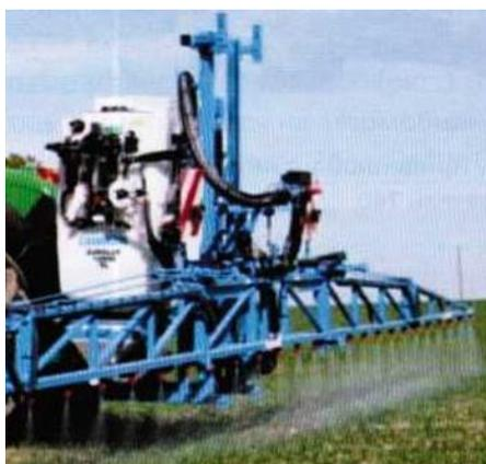
Рисунок 111 – Навесной штанговый опрыскиватель серии «Eurolux»
