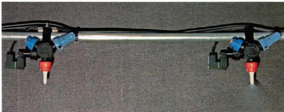
Рисунок 47 – Вентиль форсунки с сенсором контроля потока
