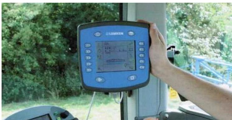
Рисунок 57 – Блок управления опрыскивателем
