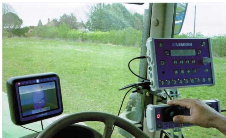
Рисунок 44 – Matrix, EcoControl и компьютер Ecospray в кабине трактора
