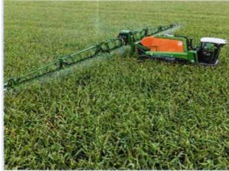
Рисунок 97 – Работа высококлиренсного опрыскивателя на посевах кукурузы
