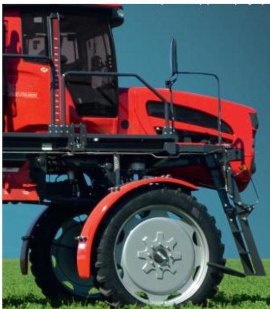
Рисунок 7 – Вид высококлиросной ходовой системы опрыскивателя УТА-3000 с шинами низкого давления
