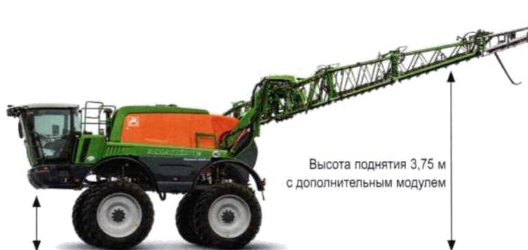
Рисунок 95 – Вид самоходного опрыскивателя Pantera 4502-Н для работы на высоких посевах кукурузы
