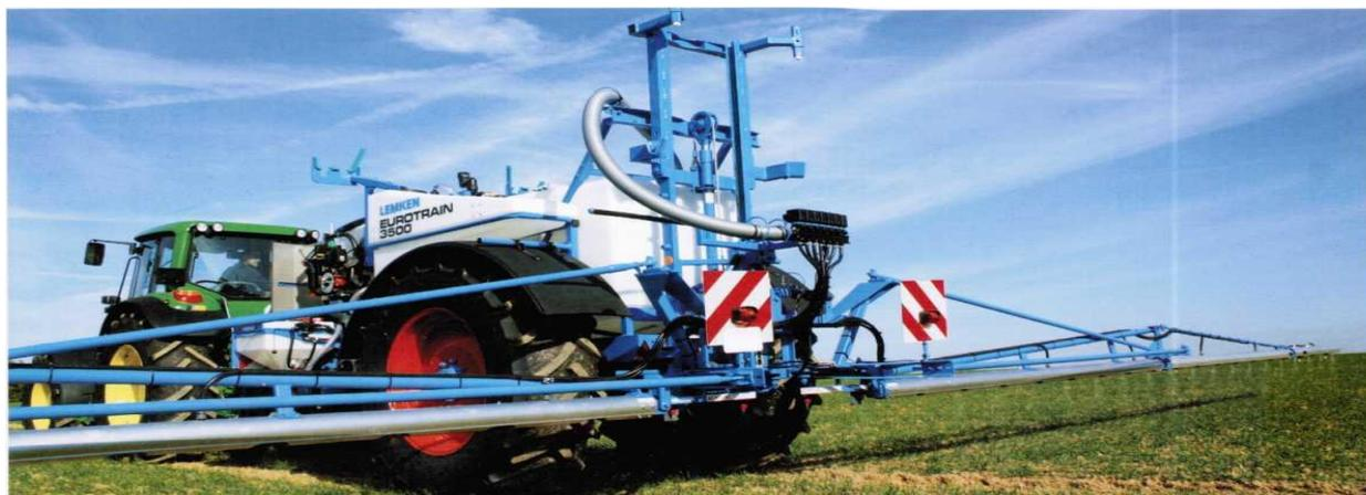
Рисунок 48 – Удобный в обслуживании прицепной опрыскиватель Евро-Трейн с проверенными алюминиевыми штангами
