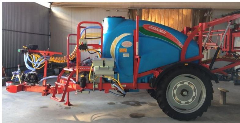
Рисунок 29 – Прицепной опрыскиватель на 3000 литров компании «АгроГруппДПол»
