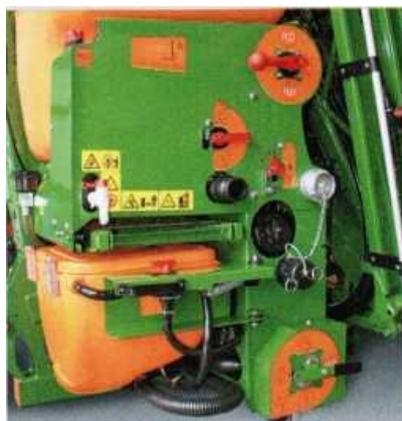
Рисунок 63 – Пост управления опрыскивателя *UF 1201*
