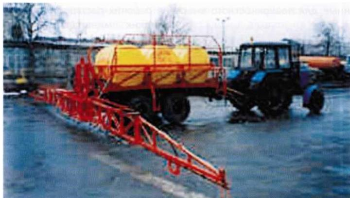
Рисунок 3 - Полуприцепной штанговый опрыскиватель ОПМ-6000
