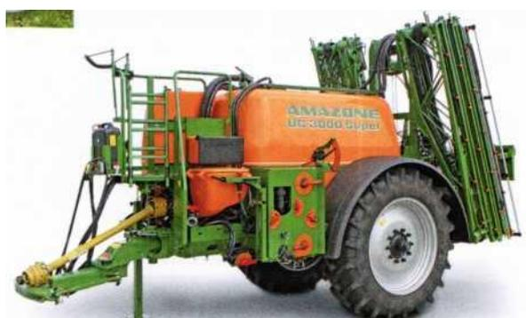
Рисунок 89 – Прицепной опрыскиватель UG 3000 Super в транспортном положении
