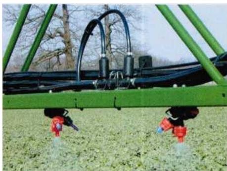
Рисунок 93 – Вид форсунок и принудительной системы циркуляции DUS
