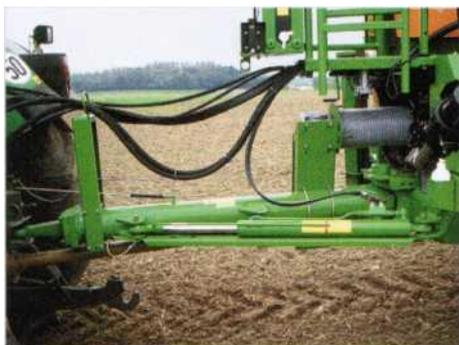
Рисунок 91 – Вид дышла с гидравлической корректировкой
