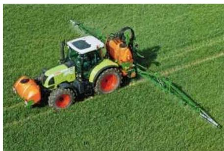
Рисунок 71 – Вид опрыскивателя FT 1001 в работе
