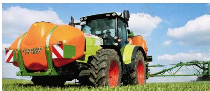
Рисунок 67 – Вид опрыскивателя с фронтальным баком FT 1001 с UF 1801 и штангой Super-S
