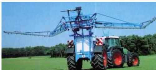
Рисунок 50 – Устойчивые к скручиванию штанги при складывании
