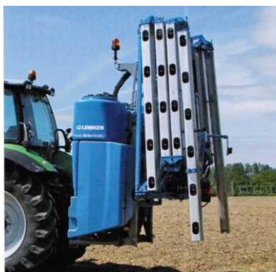
Рисунок 39 – Сложенные штанги SectionExtend
