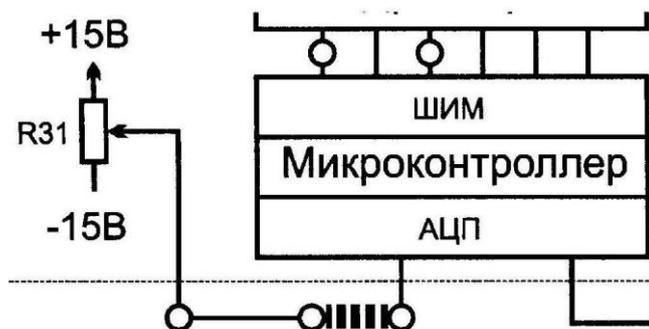
Рисунок 70. Подключение задания к инвертору
