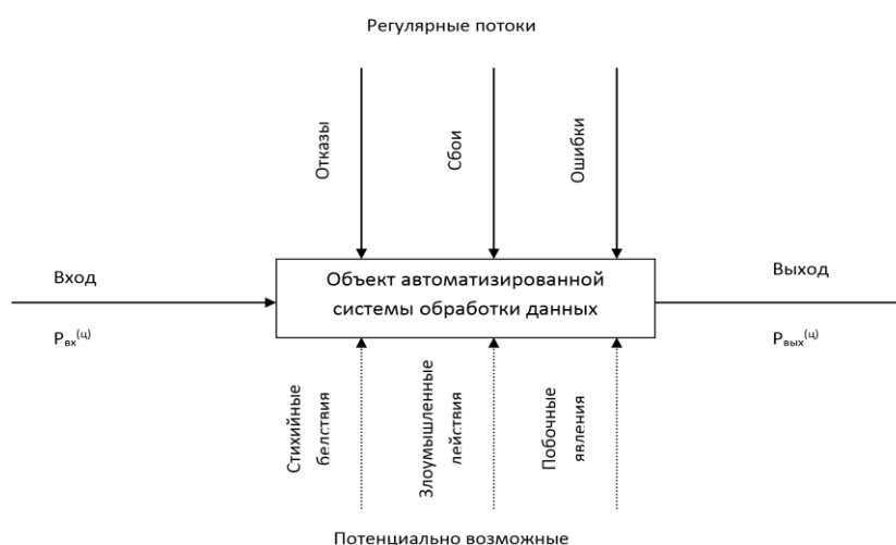
Рисунок 2 – Общая модель процесса нарушения физической целостности информации на объекте АСОД
