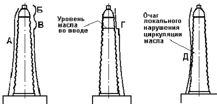
Рисунок 12 – Характер распределения температуры по высоте маслонаполненного ввода: нормальное распределение температуры (А); распределение температуры при наличии короткозамкнутого контура в маслорасширителе (Б); при перегреве внутренних контактных соединений (В); при понижении уровня масла (Г); при нарушении циркуляции масла (разбухание бумажного остова на токоведущем стержне, шламообразование и т.п.) (Д).
