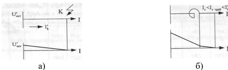
Рисунок 3 – Схема, поясняющая падение напряжения в кабельных линиях: а) при отсутствии реактора; б) при наличии реактора.
