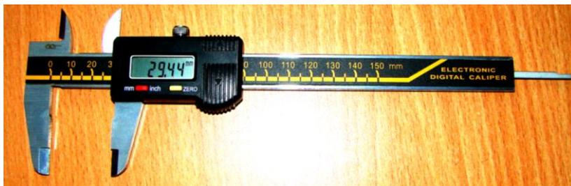
Рисунок 4 – Электронный штангенциркуль (ELEKTRONIK DIGITAL CALIPER)
