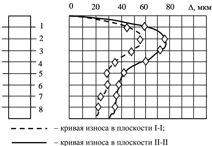
Рисунок 7 – Кривые, характеризующие износ гильзы
