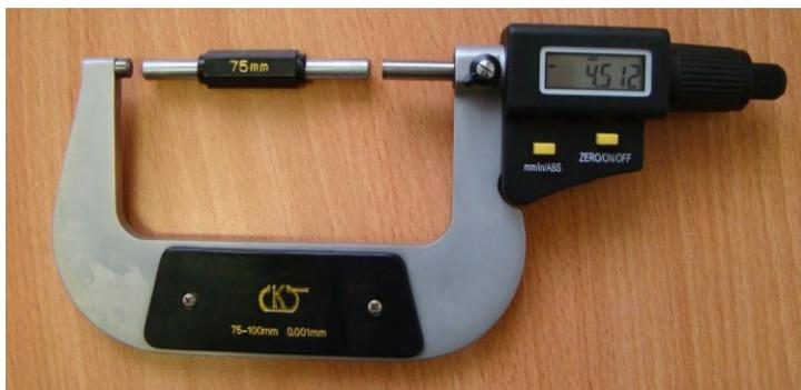
Рисунок 2 – Микрометр электронный гладкий типа МК
