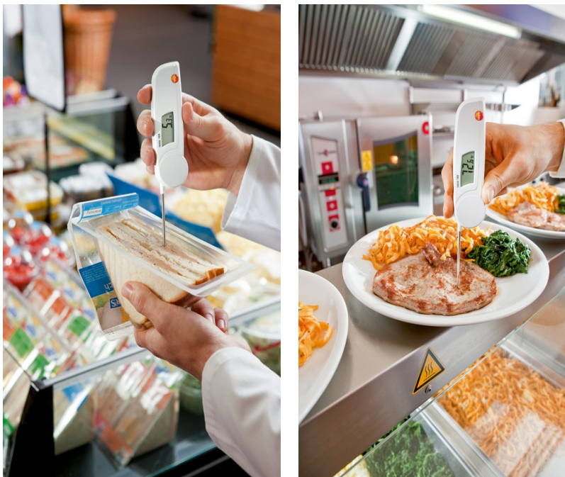
Рисунок 4 – Измерение температуры продуктов универсальным складным термометром
