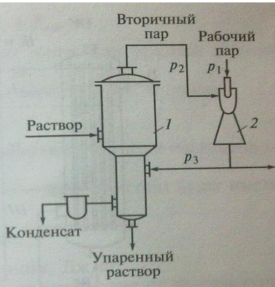
Рис. 4.22. Схема выпарной установки с инжектором: 1 — выпарной аппарат; 2 — инжектор (струйный компрессор)
