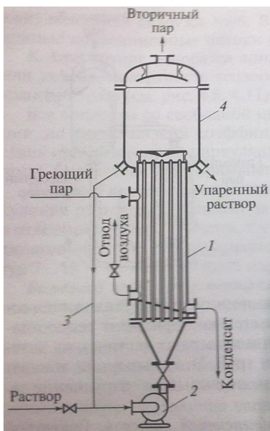
Рис. 4.15. Выпарной аппарат с принудительной циркуляцией: 1 — кипятильник; 2 — циркуляционный насос; 3 — циркуляционная труба; 4 — сепаратор
