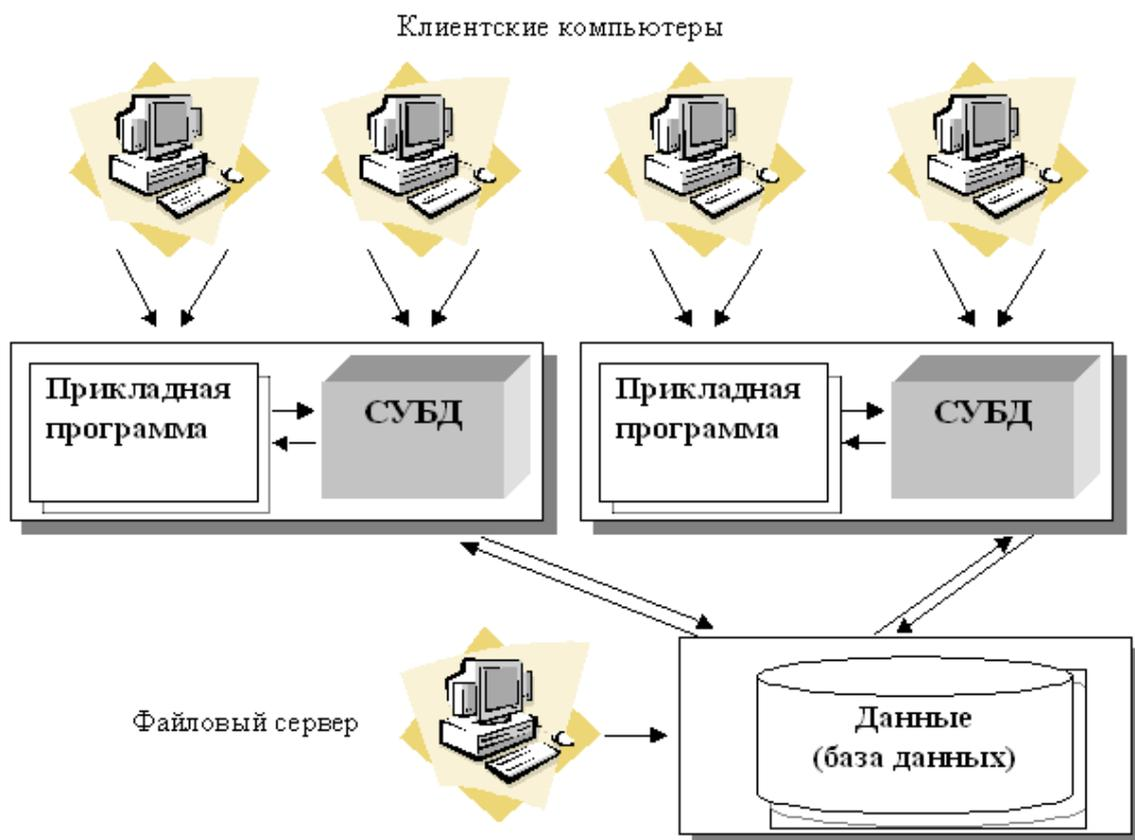
Рисунок 2 - Архитектура "файл-сервер"
