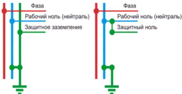
Рис. 25. Отличие защитного заземления и защитного "нуля"
