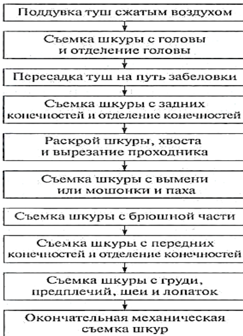
Рис. 2. Схема последовательности выполнения операций при съемке шкур с туш крупного рогатого скота
