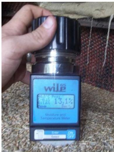
Рисунок 4.7 - Влагомер зерна Wile-65 компании «Farmcomp Agroelektronics»
