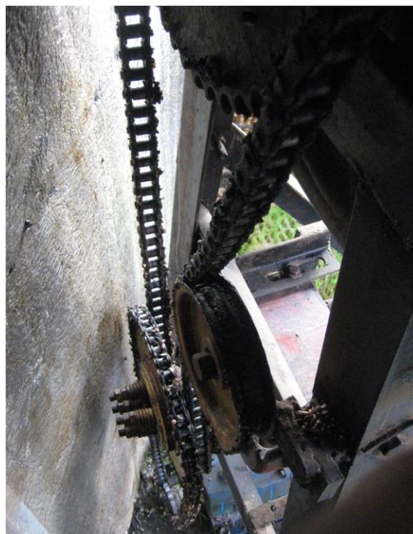
Рисунок 5.5 - Привод барабана
