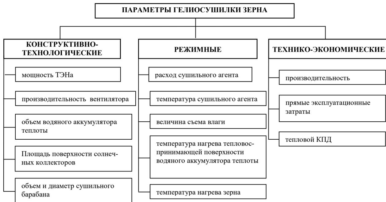
Рисунок 4.2 - Классификация параметров гелиосушилки с водяным аккумулятором теплоты и резервными системами вентиляции и электроподогрева сушильного агента
