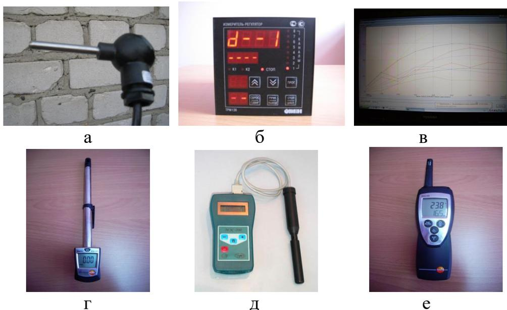
а - датчик термосопротивления ДТС 015-50М.В3.500; б - восьмиканальный измеритель-регулятор температуры ТРМ 138; в - фиксация показаний 8 датчиков на ЭВМ с построением графика; г - термоанемометр testo 405; д - метеометр МЭС-200; е - термогигрометр testo 625
