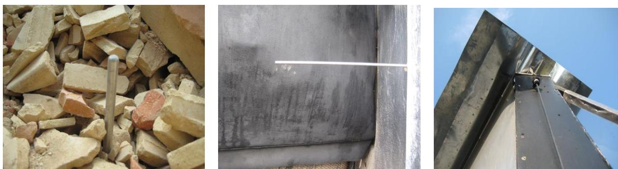
Рисунок 5.9 - Датчик термосопротивления в гравийном аккумуляторе, в сушильной камере и в верхнем коллекторе
