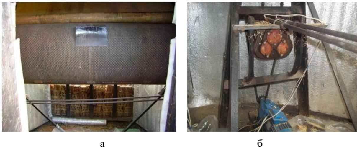
Рисунок 6.6 – Система электроподогрева сушильного агента:
