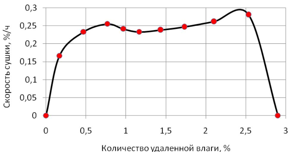
Рисунок 6.23 – Кривая скорости сушки при включенных системах активной вентиляции и электроподогрева (с 4 по 6 точки замера от нулевой вентилятор отключен)
