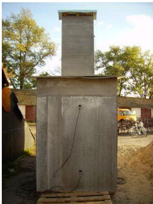
Рисунок 8.6 – Расположение датчиков температуры
