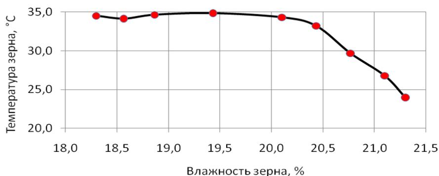
Рисунок 6.26 – Температурная кривая сушки при включенной системе электроподогрева (активная вентиляция включена после 4 ч сушки)
