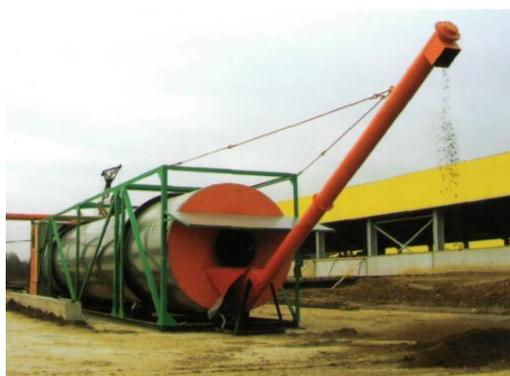
Рис. 8.12. Установка для переработки твердого навоза в подстилку фирмы «Биокомплекс»
