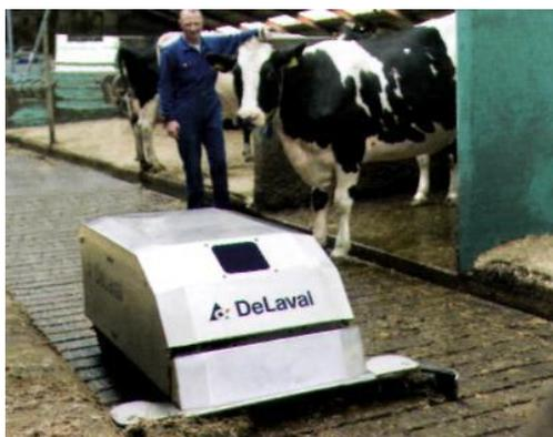
Рис. 8.9. Робот для уборки навоза в проходах
