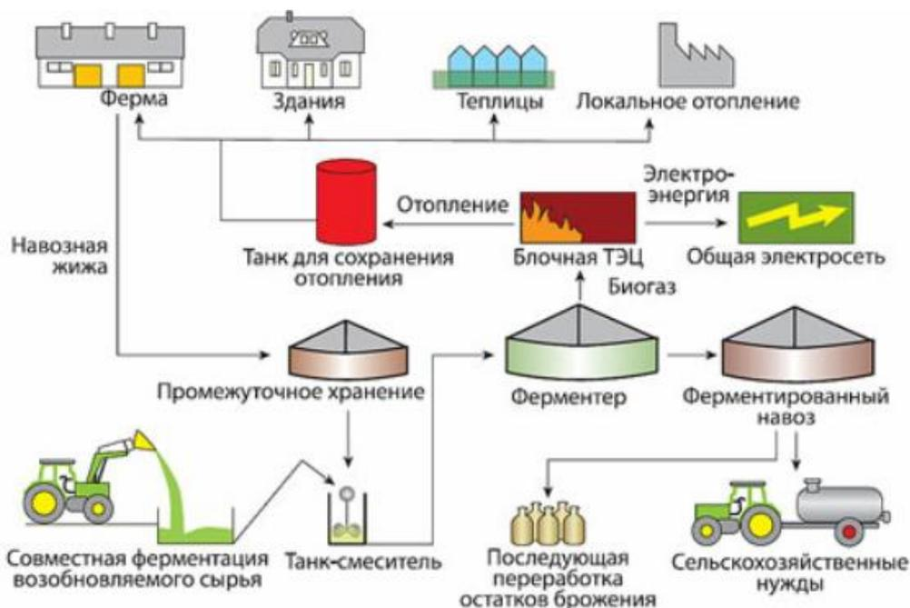
Рис. 8.13. Схема утилизации навоза с применением биогазовой установки
