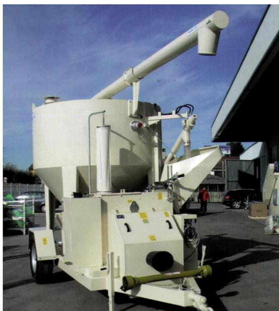
Рис. 3.15. Мобильный агрегат для приготовления комбикормов MESMAR
