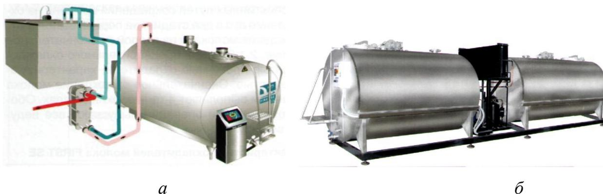
Рис. 7.24. Технологическая схема охлаждения молока с использованием проточного пластинчатого охладителя (оборудование фирмы «Зегар») (а); агрегат в составе танка-охладителя и танка-термоса (б)
