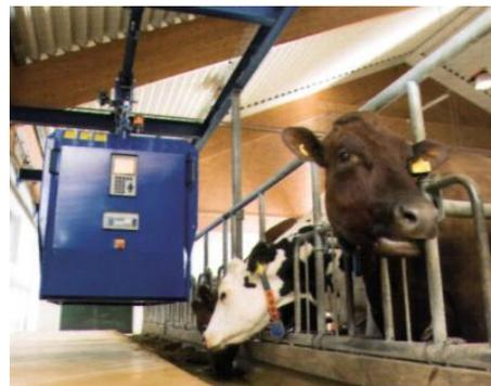
Рис. 4.2. Раздача кормов с использованием кормовых вагонов
