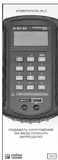
Рис. 3. Лицевая панель блока 533 с прибором E7-22.
