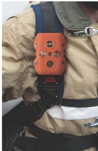
Рисунок 10.4 - Пример установки МС на лямке дыхательного аппарата
