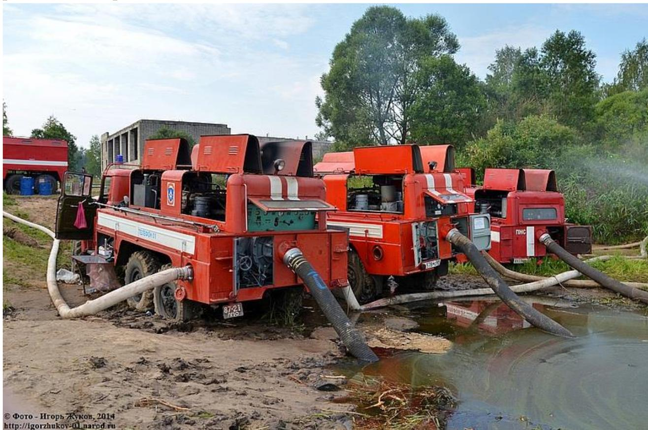
Рисунок 13.3 - Пожарные насосные станции ПНС-110
