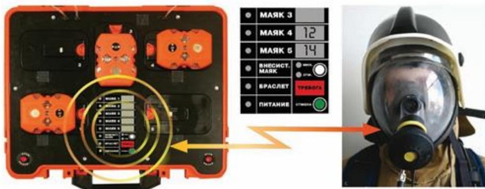
Рисунок 11.4 - Функция контроля давления и запаса воздуха
