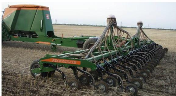
Рисунок 1 - Сеялка Condor для технологий MINI-Till, NO-Till
