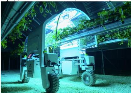
Рисунок 1 – Робот Thorvald, SAGA Robotics, Норвегия. Предназначен для ультрафиолетовой обработки растений. Источник изображения: [sagarobotics.com](http://sagarobotics.com).
