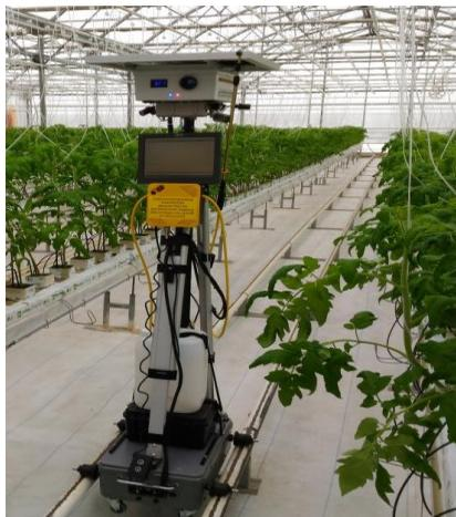
Рисунок 2 – Роботизированная платформа для интегрированной защиты тепличных растений от болезней
