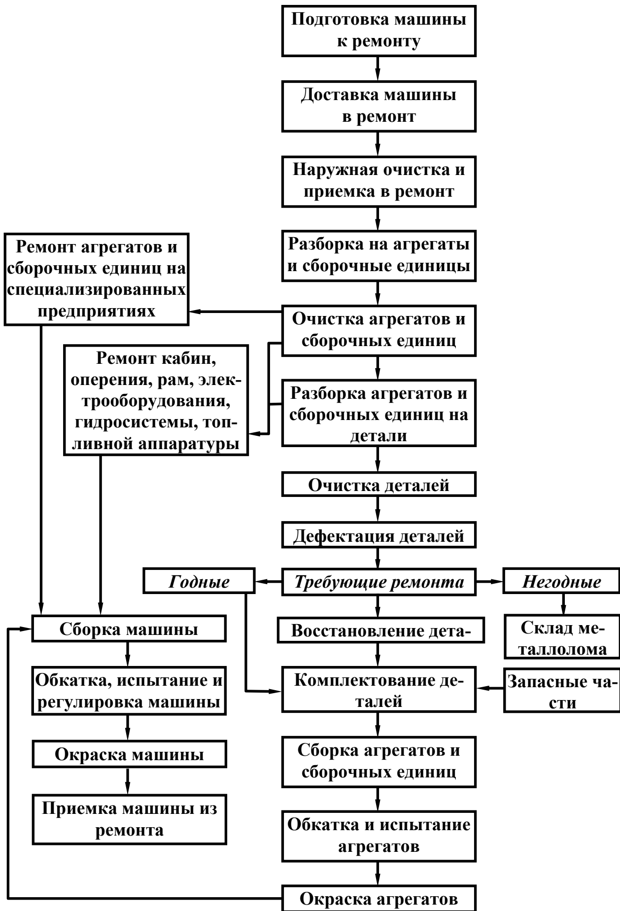
Рисунок 3 - Схема технологического процесса ремонта сложной машины
