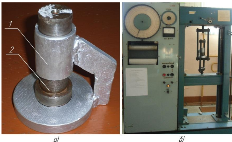
Рисунок 2 – Схема установки для определения усилия резания волокон исследуемого материала
