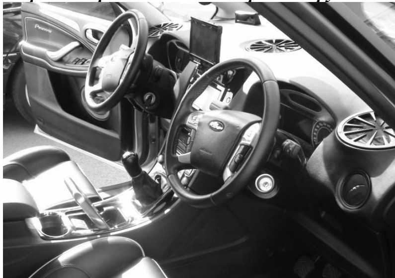
Рисунок 5.2 – Левостороннее и правостороннее рулевое управление
