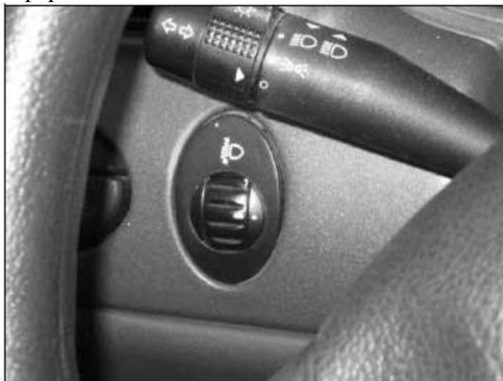
Рисунок 6.12 – Электрический корректор фар
