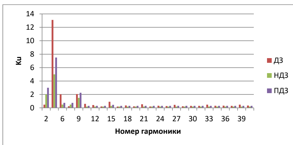
Рис. 7 - Гистограмма коэффициентов n -гармонических составляющих напряжения фазы А на шинах 0,4 кВ электродвигателя второй печи (ДЗ – действующее значение; НДЗ – нормально-допустимое значение; ПДЗ – предельно-допустимое значение)
