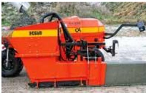
Устройство бортового камня с помощью CurbAppeal CLS600
