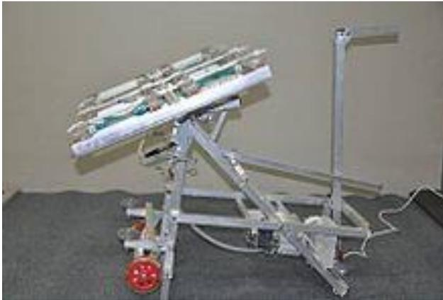
Рис. 1 Аппарат-Плиткоукладчик Черепановых
