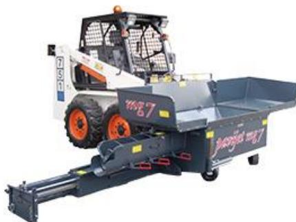
Данная модель может быть навешена сзади. Очень удобно использовать там, где нет возможности двигаться вперед из-за нехватки площади. По принципу такой же, как и MG7, но у MG6 D1 два выдвижных выравнивателя.
