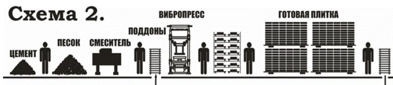
Линия по производству тротуарной плитки (по ГОСТу 17608-91) проходит промышленным способом с применением цемента, воды и заполнителя. Есть два основных метода: вибролитье и вибропрессование смесей.
