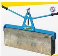
Захват продольный навесной (на троссовый подвес) для механизированной переноски и установки бордюров весом до 150 кг. Имеет регулировку по длине захвата
