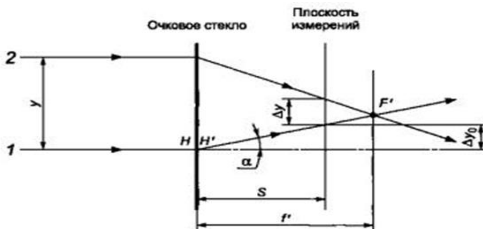
Рис. 2.4. Принципиальная схема дополнительного метода испытания на сферическую рефракцию и астигматизма на малых участках очковых стекол: u – расстояние между параллельными световыми лучами 1 и 2, мм; f' – заднее фокусное расстояние очкового стекла, м; \Delta y_0 – линейное отклонение осевого луча 1 в плоскости измерения, мм; \alpha – угол отклонения осевого луча 1; \Delta y – расстояние между точками пересечения преломленных лучей 1 и 2 с плоскостью измерения, мм
