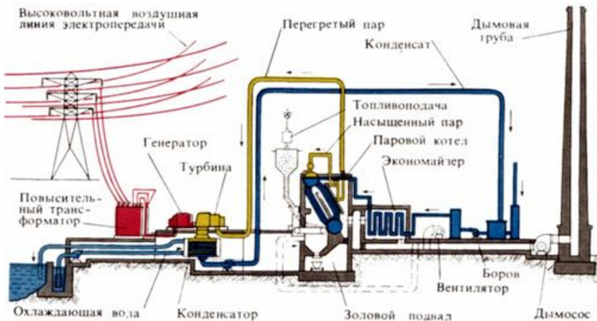
Рисунок 1.2 - Схема тепловой конденсационной электростанции
