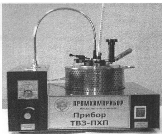
Рисунок 2.1 – Внешний вид аппарата ТВЗ – ПХП
