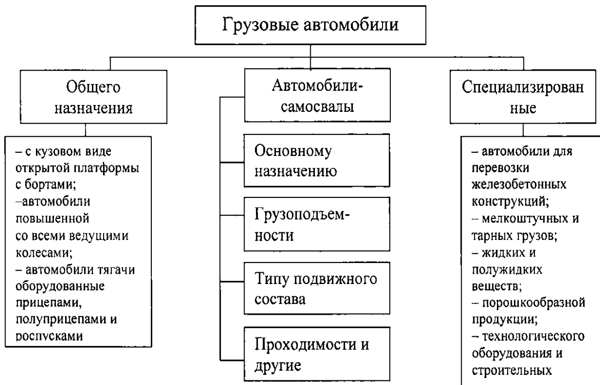
Рис. 2. Классификация грузовых автомобилей
