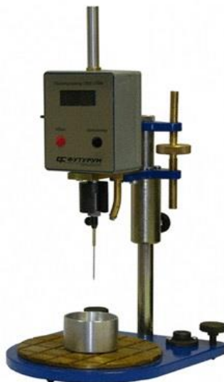
Рис. 5.2. Пенетрометр битумный автоматический ПБА-1ФМ по ГОСТ 1440-78. Предназначен для определения вязкости нефтяных дорожных битумов и прочих нефтепродуктов по методу определения глубины проникания иглы в испытуемый образец при заданной нагрузке, температуре и времени и выражается в единицах соответствующих 0,1 мм.
