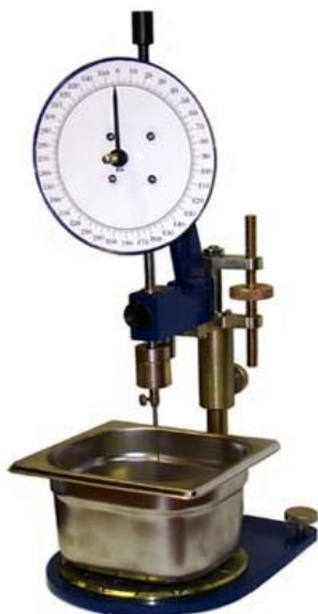
Рис. 5.1. Пенетрометр М-984 ПК. Предназначен для определения пенетрации дорожных нефтяных битумов и прочих нефтепродуктов по методу определения глубины проникания иглы в испытуемый образец при заданной нагрузке, температуре в единицах соответствующих 0,1 мм.
