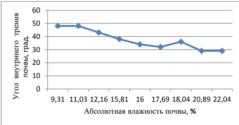
Рис. 4.8. Зависимость значений угла внутреннего трения от абсолютной влажности среднесуглинистой почвы
