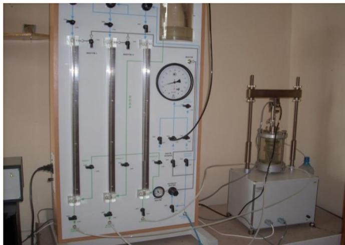
Рис. 3.11. Камера сжатия стабилометра
