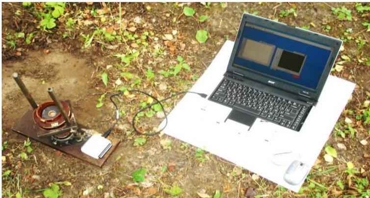
Рис. 3.17. Система измерений технической частоты в сборе
