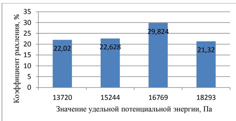
Рис. 4.13. Зависимость коэффициента рыхления от удельной потенциальной энергии при влажности 17,69%
