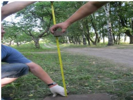
Рис. 3.26. К определению высоты падения разрушения
