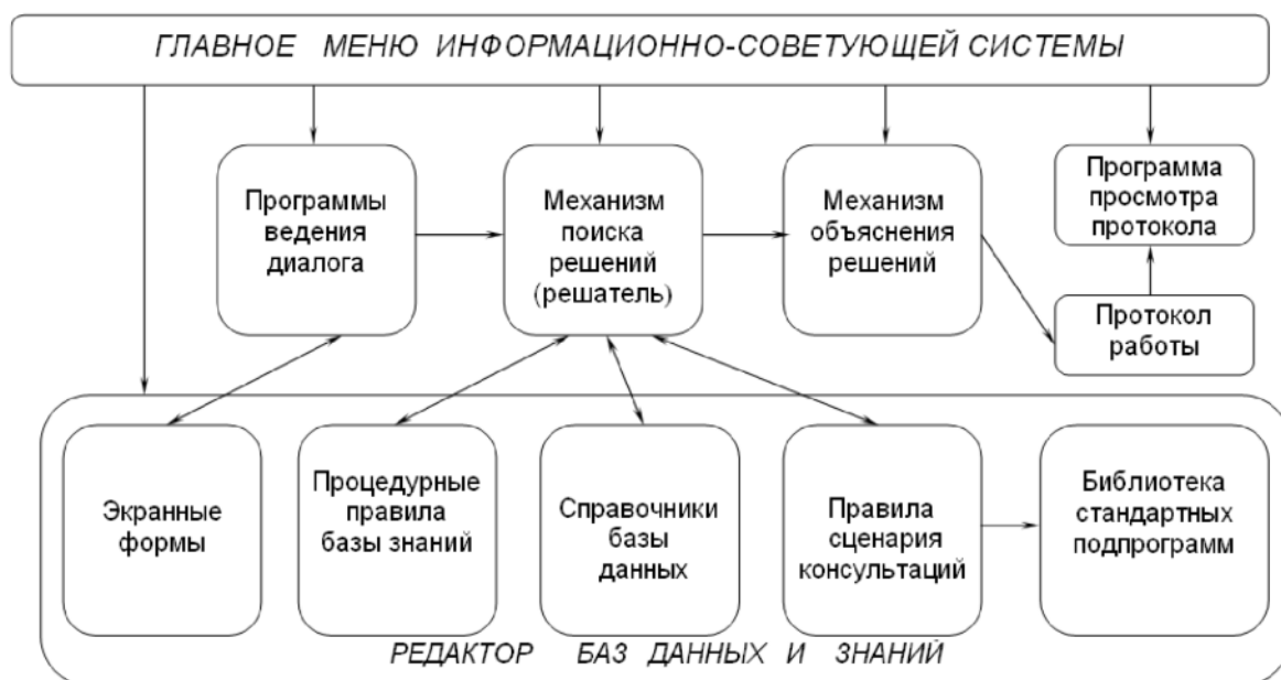
Рисунок 8.1 - Структурная схема программно-информационного обеспечения ИСС УПОП
