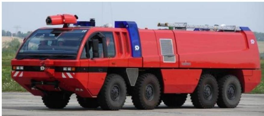
Рисунок 5 - Avenger 8x8 аэродромный пожарный автомобиль
