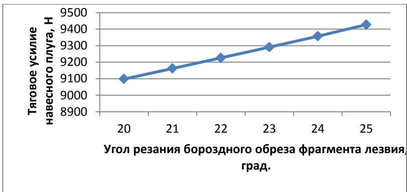
Рисунок 2 – Тяговое усилие навесного плуга в зависимости от угла резания бороздного среза лемеха
