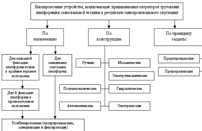
Рисунок 1 – Классификация технических средств безопасности грузовых самосвальных платформ
