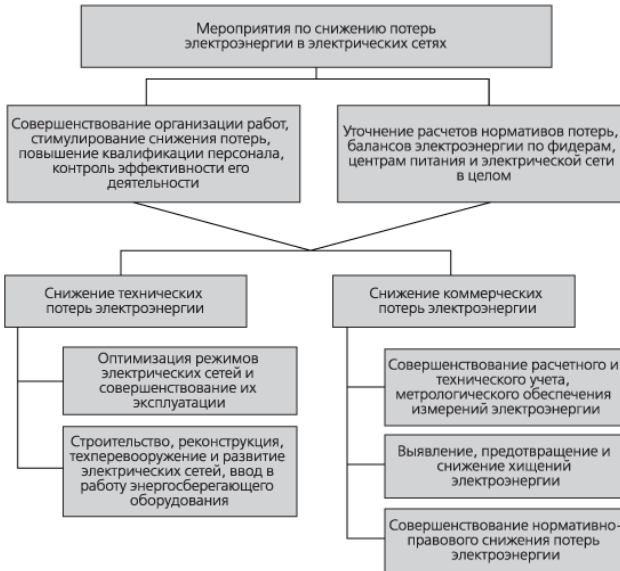
Рис. 1. Мероприятия электроэнергетики для снижения потерь электроэнергии
