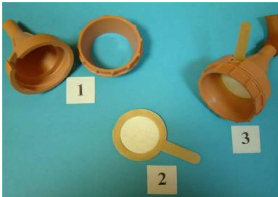
Рисунок 6 – Фильтродержатель ИРА-10: 1 – фильтродержатель, 2 – фильтр АФА, 3 – фильтр в фильтродержателе, соединенном с гибким шлангом
