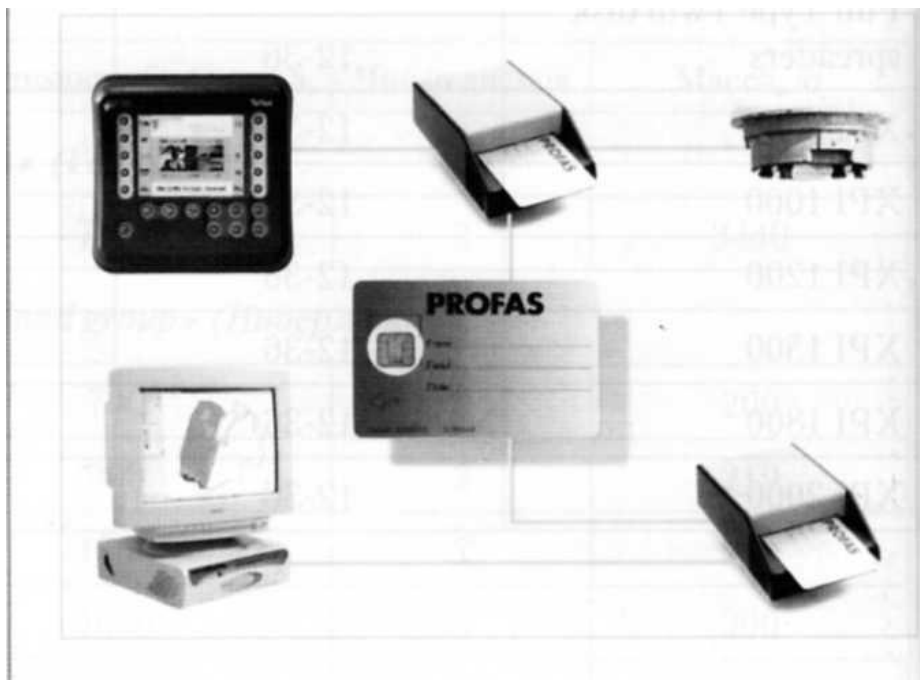
Рисунок 1.5 - Структурная схема системы ProFas фирмы «Vicon» («Kvernelandgroup», Нидерланды) для использования разбрасывателей удобрений в точном земледелии
