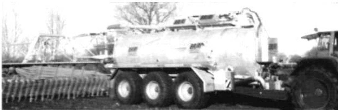
Рисунок 1.20 - Трехосная цистерна для внесения ЖОУ фирмы «Vgiri» (Германия) с волокушно-шланговыми жижераспределителями.
