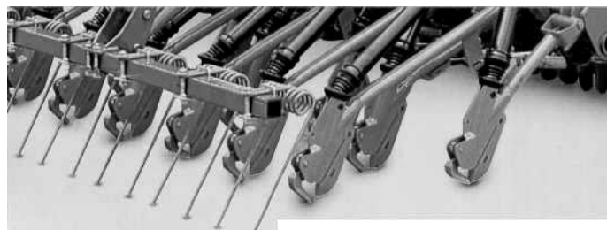
Рисунок 4.34 - Сошник WS и выравниватель зубьями с тупым углом атаки
