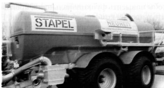
Рисунок 1.21 - Цистерна для внесения ЖОУ из полиэфира фирмы «Stapel» (Германия)
