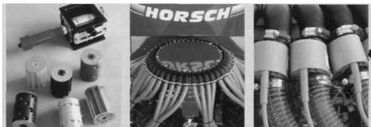
Рисунок 4.13 - Вид дозирующего аппарата со сменными роторами и датчиками контроля потока семян
