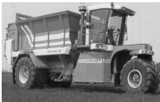
Рисунок – 1.15 Тип ходовой системы «одно колесо на колею»
