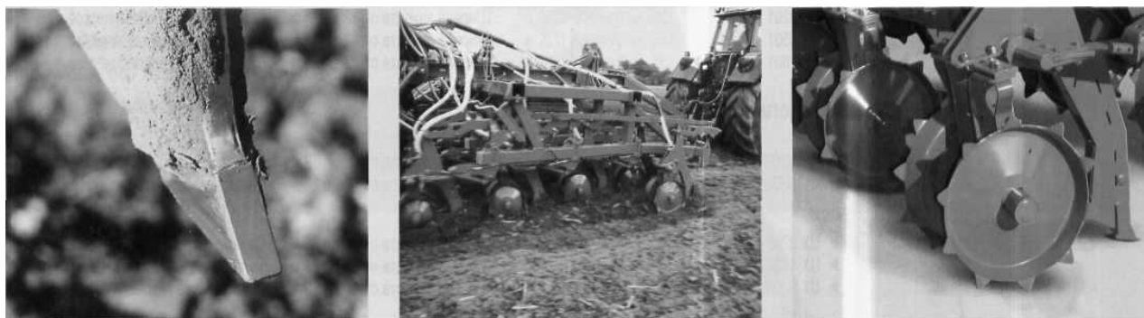
Рисунок 4.26 - Вид бронированного долотовидного сошника и сдвоенных заделывающих дисков
