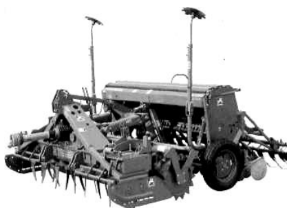
Рисунок 4.1 - Сеялка ADSuper + KG 40З шириной захвата 4 метра
