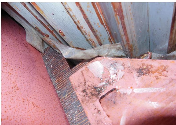
Рис. 2. Низкое качество ремонта трансформатора: загрязнение поверхности отдельных узлов трансформатора вызвало частичные разряды порядка 1000 пКл, сработала газовая защита (фото авторов работы с места аварии)
