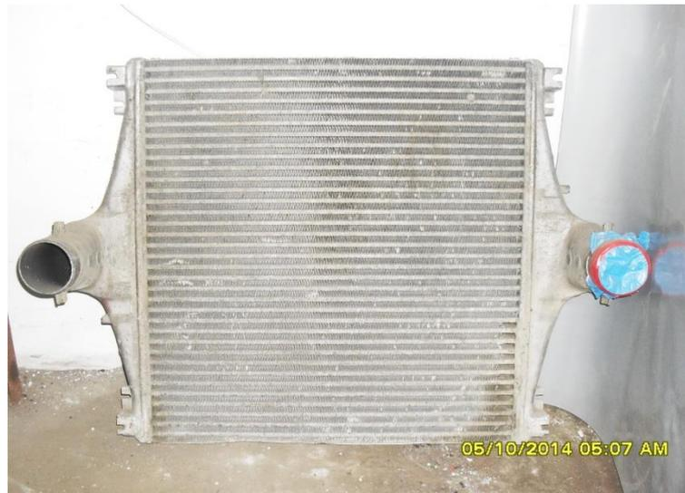
Рис. 4. Радиатор (интеркулер) импортного производства после ремонта
