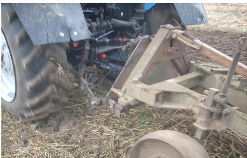
Рис. 5. Устройство для динамометрирования навесного плуга ПЛН-3-35 [9]
