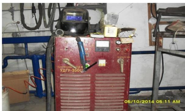
Рис. 1. Сварочный аппарат УДГУ 350сэ
