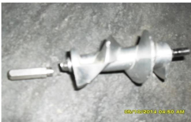
Рис. 2. Шнек в разрушенном виде
