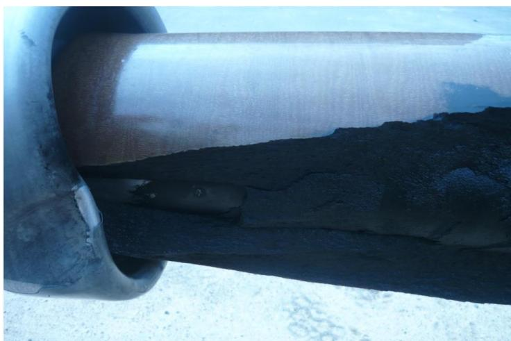
Рис. 1. Иллюстрация низкого качества изготовления ввода 330 кВ с RIP-изоляцией. Взрыв ввода в баке трансформатора (фото авторов работы с места аварии)
