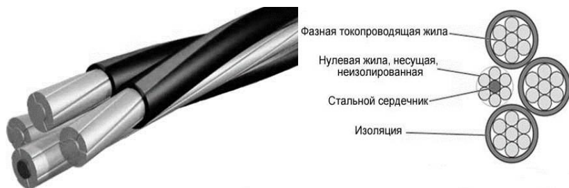
Рис. 24. Эскиз самонесущего изолированного провода
