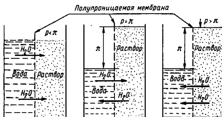
Рис. 2. Схема механизма обратного осмоса
