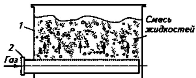
Рис. 6. Схема пневматического смесителя (барботера)
