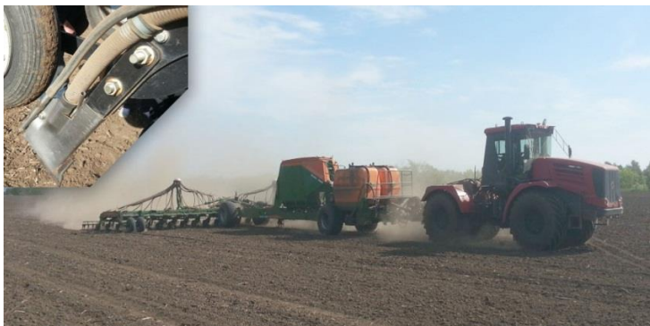
Рис. 2. Универсальный агрегат FDC 6000 с сеялкой Condor 12000 с долотовидными сошниками для прямого посева и приспособлением для одновременного внутрпочвенного внесения твердых и жидких минеральных удобрений
