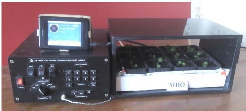
Рисунок 1– МИО семян земляники садовой активатором АМИ-3м с индуктором ИП-1
