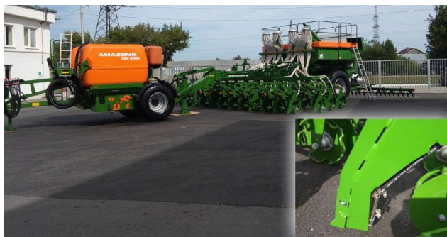
Рис. 1. Универсальный агрегат FDC 6000 с сеялкой Primera DMC 9000, оборудованной системой подачи жидких удобрений под анкерный сошник
