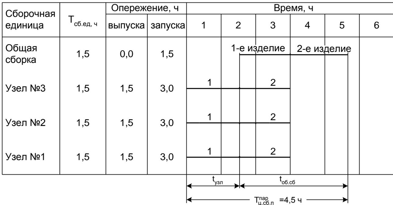
**Рис. 7.5.** График организации процесса параллельной сборки изделий при синхронизированных операциях ( $n_H = 2$ )
