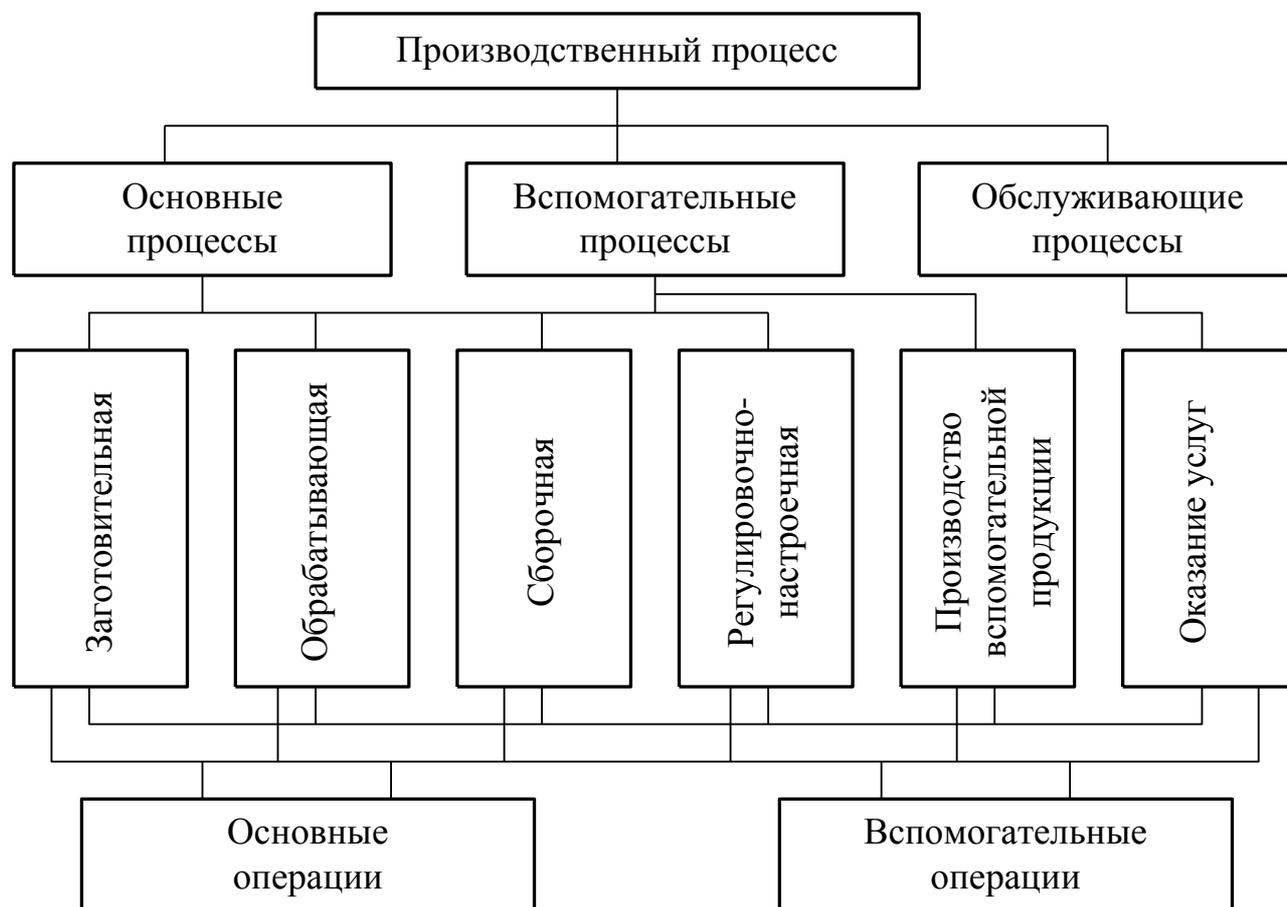
Рис.4.1. Структура производственного процесса.
