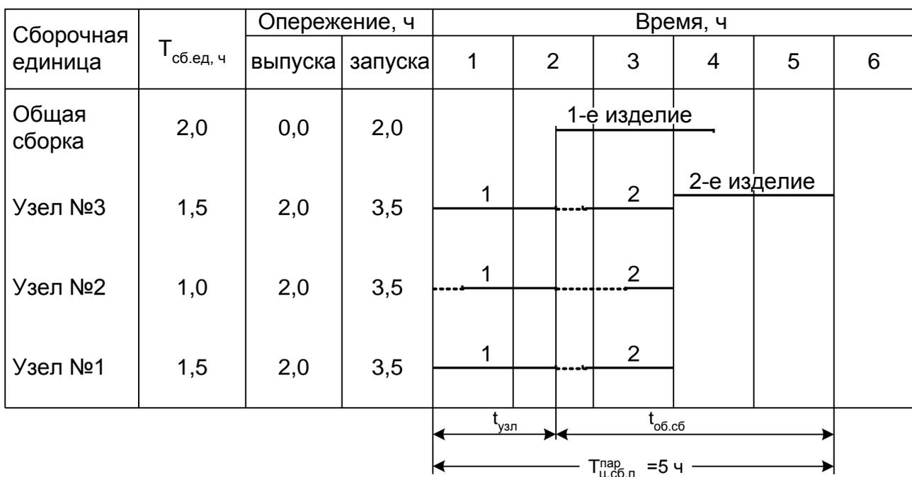
**Рис. 7.4.** График организации процесса параллельной сборки двух изделий ( $n_H = 2$ ) без синхронизации сборочных единиц
