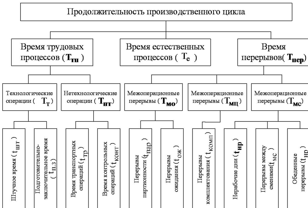
Рис. 5. 1. Структура производственного цикла
