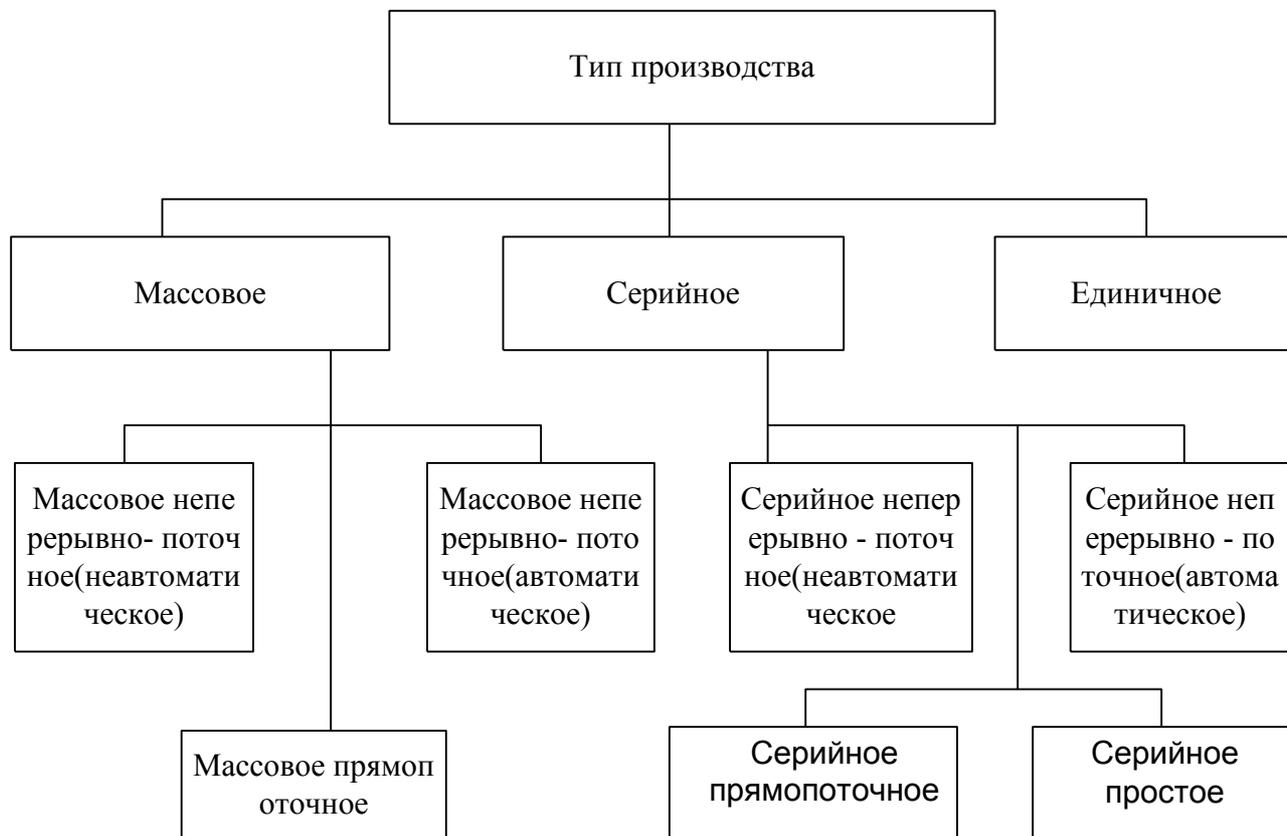
Рис.4.3. Классификация типов производства
