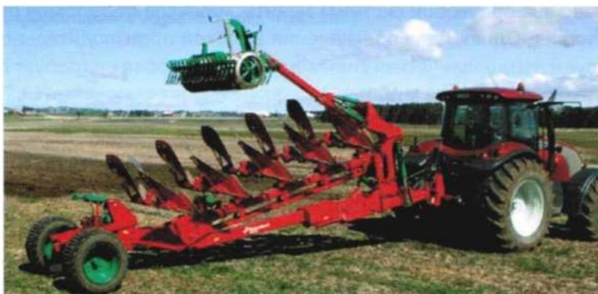
Рисунок 4.2 - Полунавесной оборотный плуг «три в одном» фирмы «Kverneland» (Норвегия)
