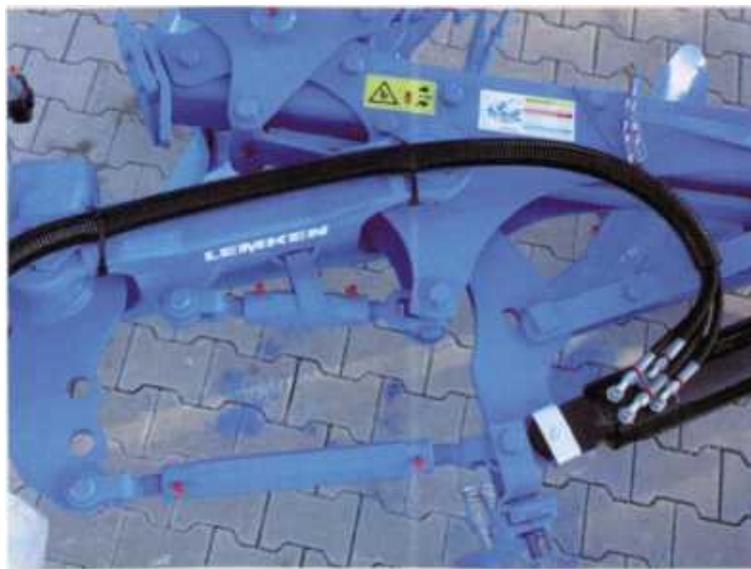
Рисунок 5.7 – Регулировочная система Optiquick плугов ВариОпал
