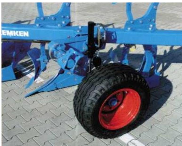
Рисунок 5.11 – Гидравлическое опорное колесо плугасерии Ювель
