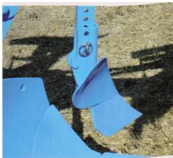
Рисунок 5.5 – Безинструментная регулировка предплужника по высоте
