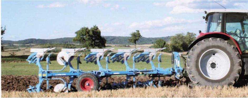
Рисунок 5.6 – Вид плуга серии ВариОпал
