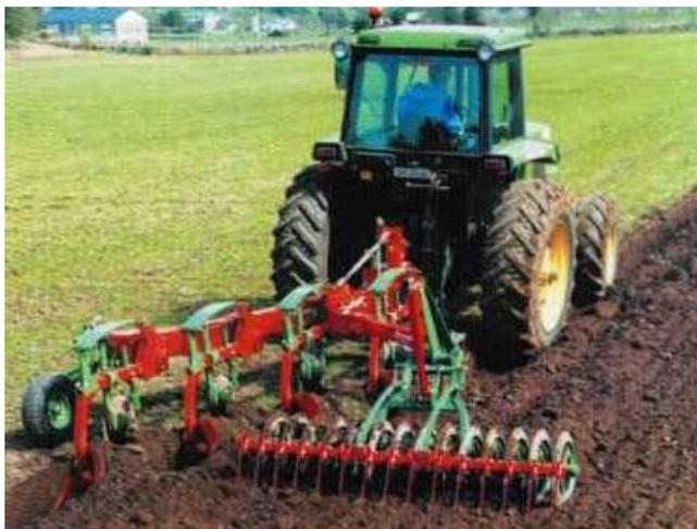
Рисунок 4.1 – Вид плуга необоротного концерна Kverneland
