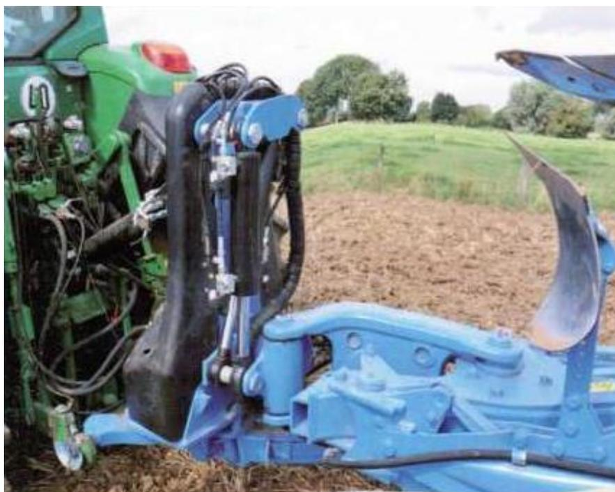
Рисунок 5.16 – Башня плуга Танзанит
