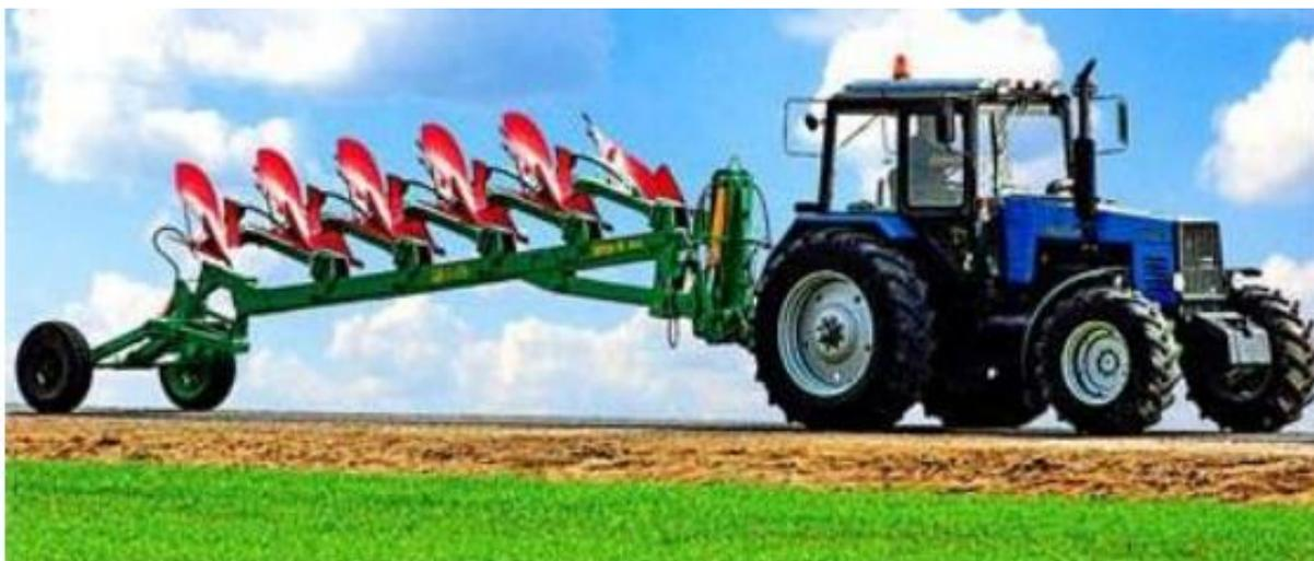
Рисунок 2.1 - Плуг оборотный полунавесной ППО-5-40
