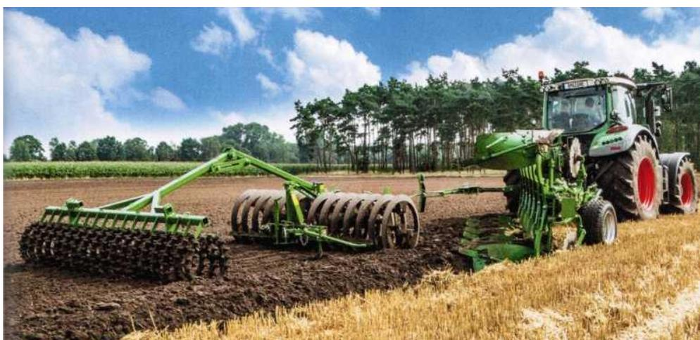
Рисунок 3.13 – Комплектация пахотного агрегата с навесным полнооборотным плугом Cayron 200 V
