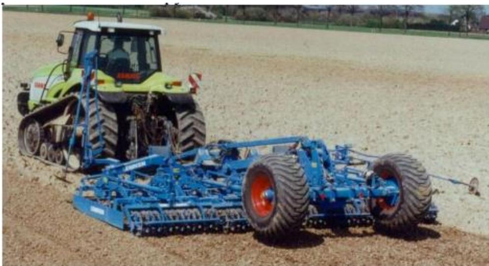
Рисунок 9.9 - Предпосевной агрегат «Система-Компактор»
