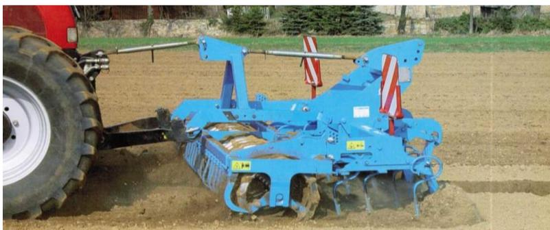
Рисунок 9.4 – Агрегат для предпосевной обработки почвы Кварц в работе
