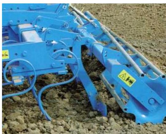
Рисунок 9.6 – Многофункциональная балка, установленная на активный срез
