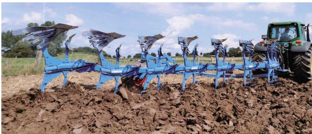
Рисунок 5.15 – Гибридный плуг Танзанит
