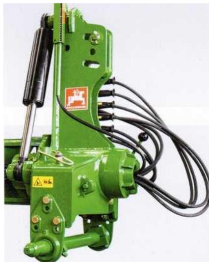
Рисунок 3.2 – Вид опорного кронштейна плуга Sauron
