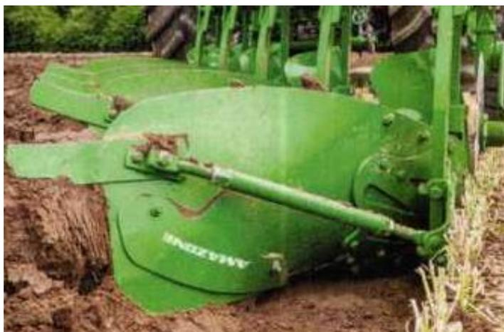
Рисунок 3.9 – Вид специальной расчищающей пластины X-Blade для увеличения удлинителя на последнем корпусе плуга
