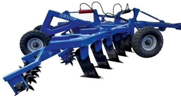
Рисунок 6.1 - Плуг чизельный прицепной
