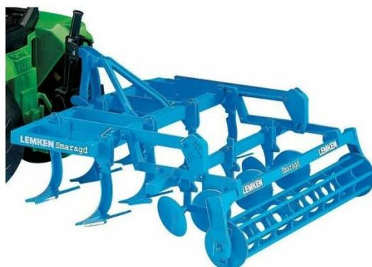
Рисунок 8.1 - Дисковый культиватор Смарагд
