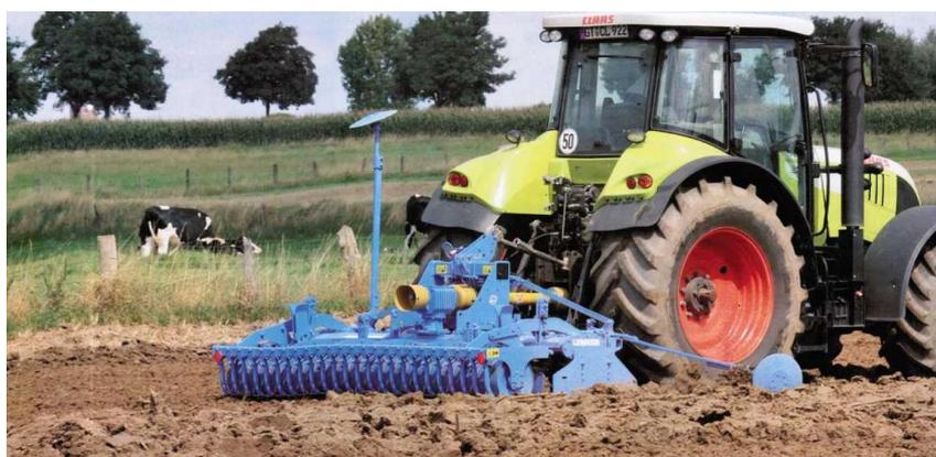
Рисунок 9.1 – Многофункциональная ротационная борона «Циркон-8»
