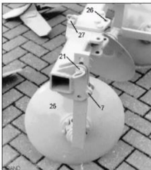
Рисунок 8.12 – Регулировка крайних дисков
