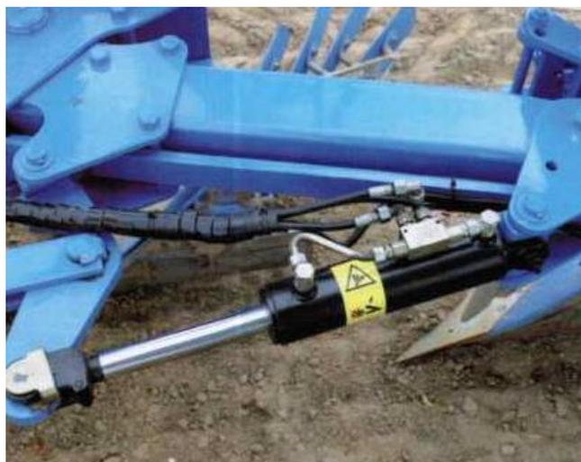
Рисунок 5.10 – Цилиндр изменения рабочей ширины захвата плуга серии Ювель
