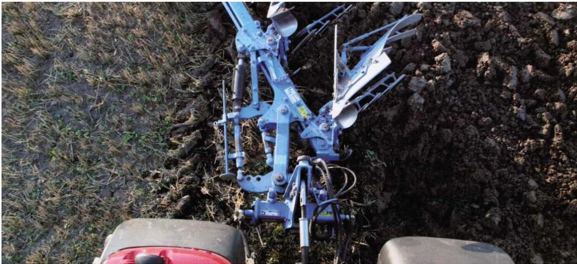
Рисунок 5.12 – Регулировочная система Optiquick
