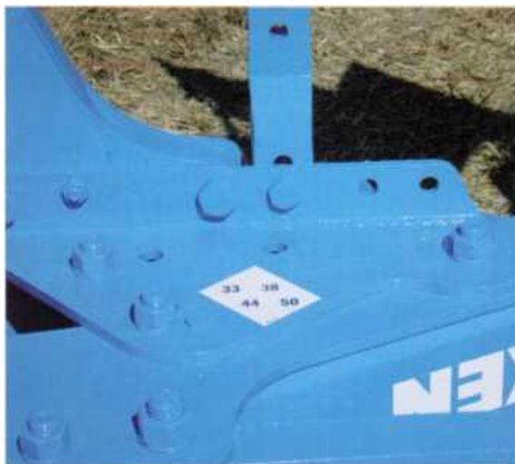
Рисунок 5.4 – Регулировка рабочей ширины захвата
