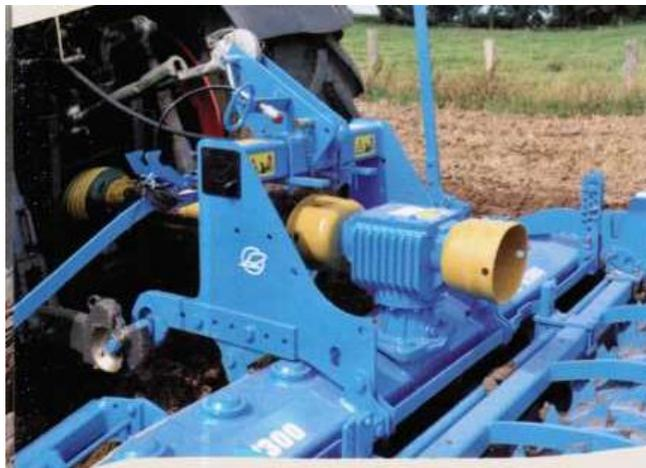
Рисунок 9.3 – Вид редуктора со сменными шестернями
