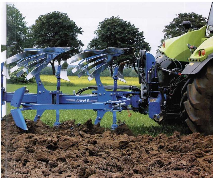
Рисунок 5.1 – Обратный плуг фирмы Лемкен с перьевыми отвалами
