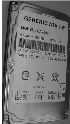
Рис. 64. Карта режимов работы жесткого диска
