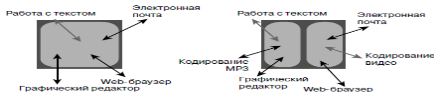
Рис.13. Работа в многозадачной системе одноядерного (слева) и двух ядерного (справа) процессоров.
