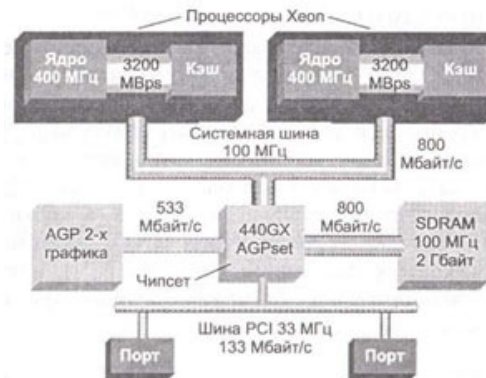
Рис. 37. Архитектура AGPSet (чипсет Intel Triton 440GX)
