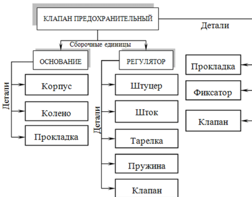
Рис.244. Структура изделия «Клапан предохранительный»
