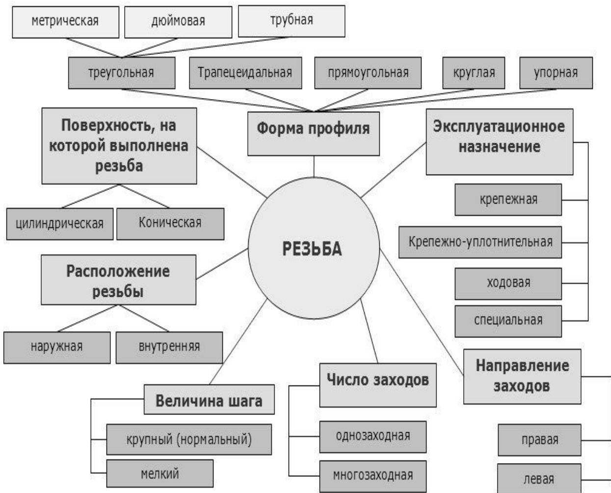
Рис. 146. Классификация резьб
