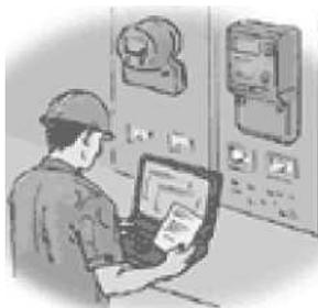
Рис. 7.1. Организация опроса счетчиков через оптический порт
