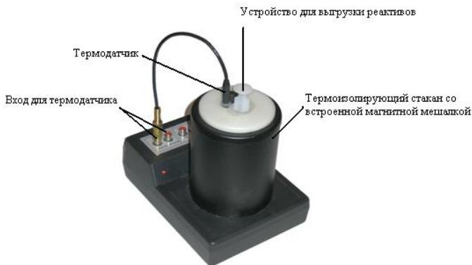
Рис. 1. Схема калориметра
